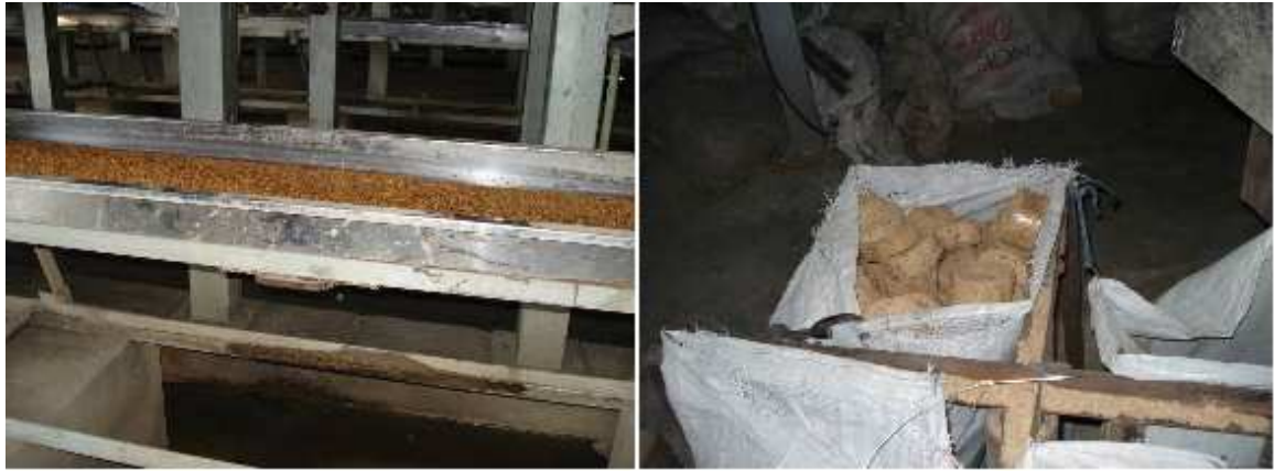
Figura 2. 10: Transporte e compactação da casca de arroz.
