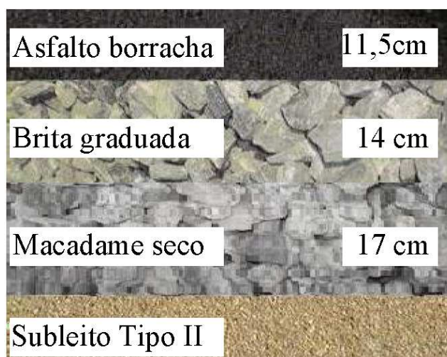
Figura 5. 4: Estrutura do pavimento flexível com mistura de asfalto-borracha seguindo a recomendação de Fontes (2009).
