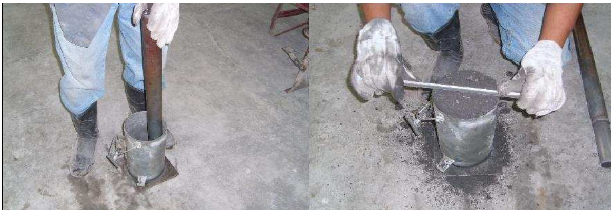
(c) compactação das camadas
