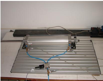
Figura A-1 – Conjunto válvula e cilindro simétrico.
