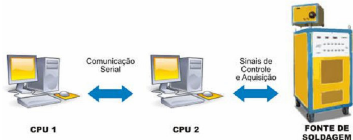
Figura 24 - Disposição física do SAC [51].
