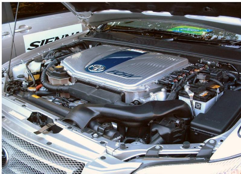
Figura 1-3 - Carro da Toyota movido a hidrogênio com célula a combustível [3]
