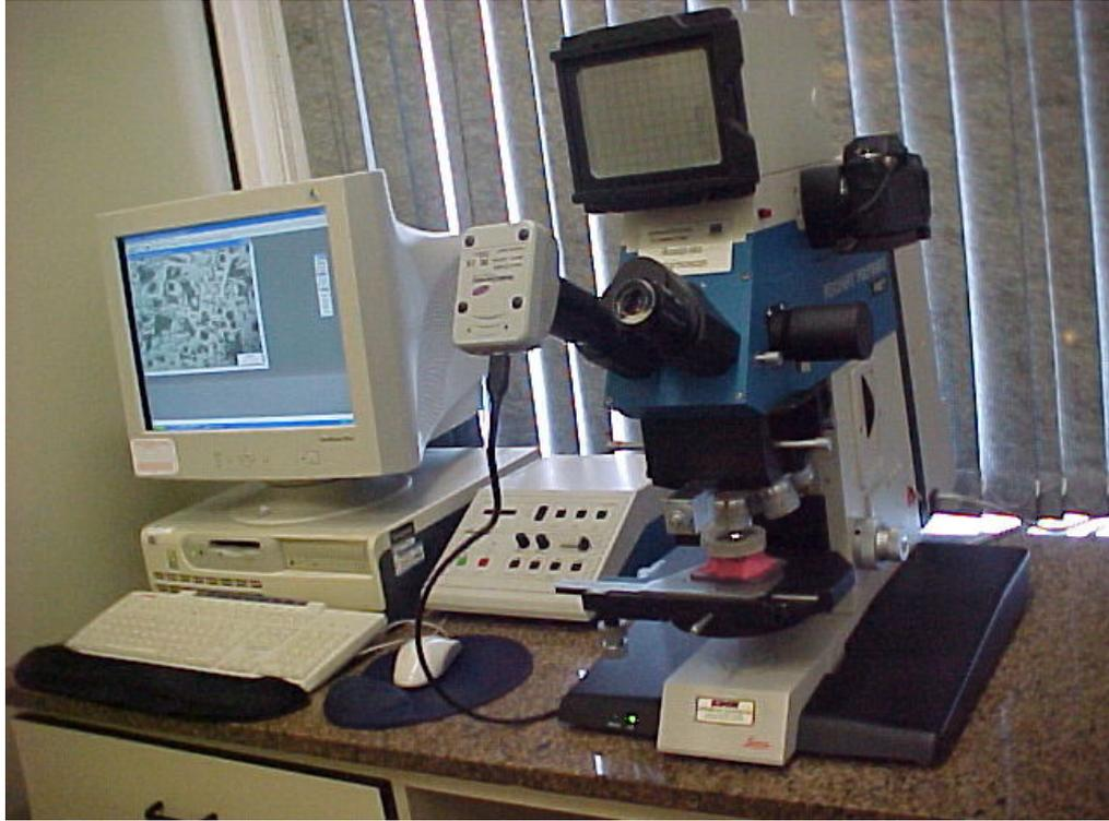
**Figura 3-15** – Bancada com microscópio óptico acoplado à câmera digital e PC com software analisador de imagens.
