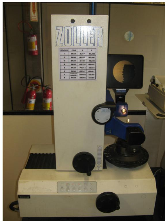
**Figura 3-11** – Máquina de *preset* de ferramentas.
