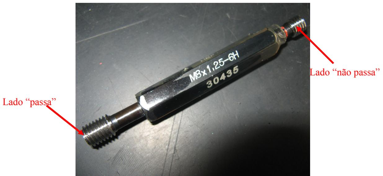
**Figura 3-3** – Calibrador, código 30435 HEF OS 7200C, para controle de roscas métricas M8x1,25.
