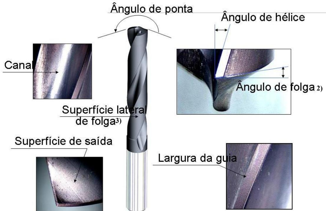
**Figura 2-15** – Outros elementos geométricos de uma broca helicoidal [6].
