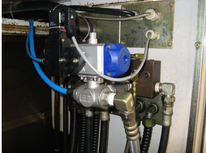
**Figura 3-9** – Válvula com acionamento por solenóide para liberação e bloqueio do *spray* pelo eixo-árvore da máquina-ferramenta.
