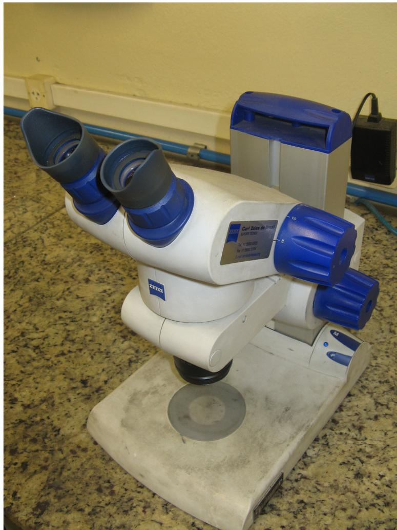
**Figura 3-14** – Estéreo-microscópio modelo DV4 da empresa Zeiss.
