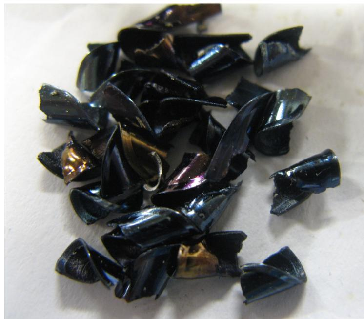
**Figura 3-13** – Forma dos cavacos normalmente gerados pelo processo de furação de eixos.
