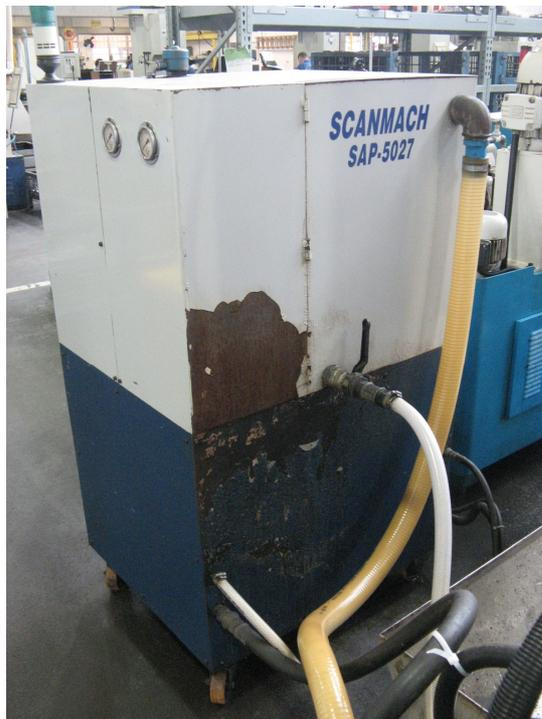
**Figura 3-10** – Bomba para alimentação interna do jato de fluido de corte.
