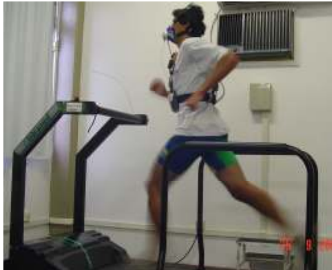
Figura 5. Esteira rolante e analisador de gases acoplado ao corredor, utilizados nos testes laboratoriais.
