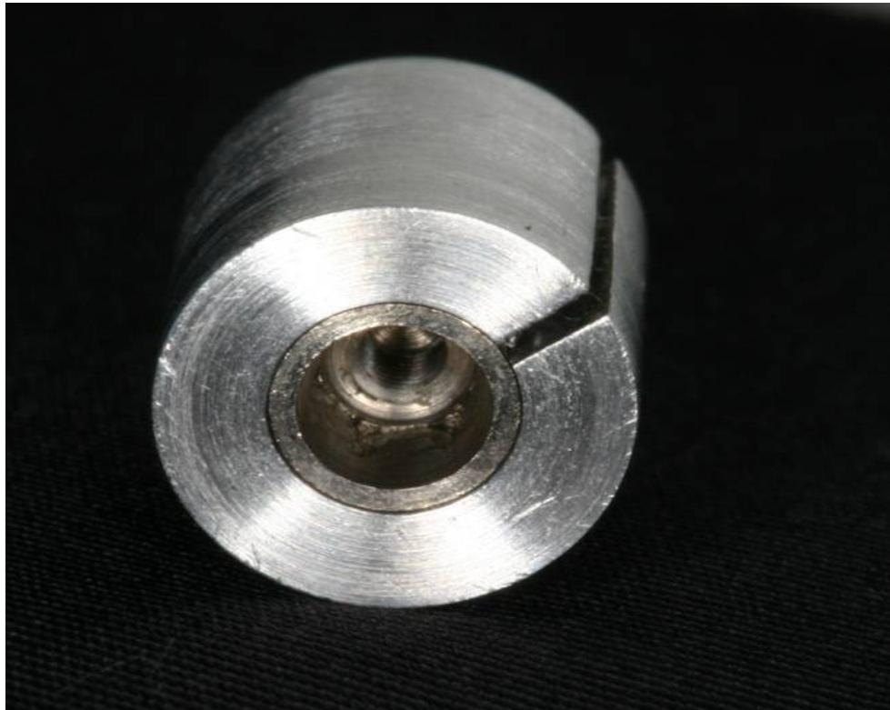
Figura 4 – implante “cone em cone” inserido no mandril de alumínio (observe a presença da fenda)
