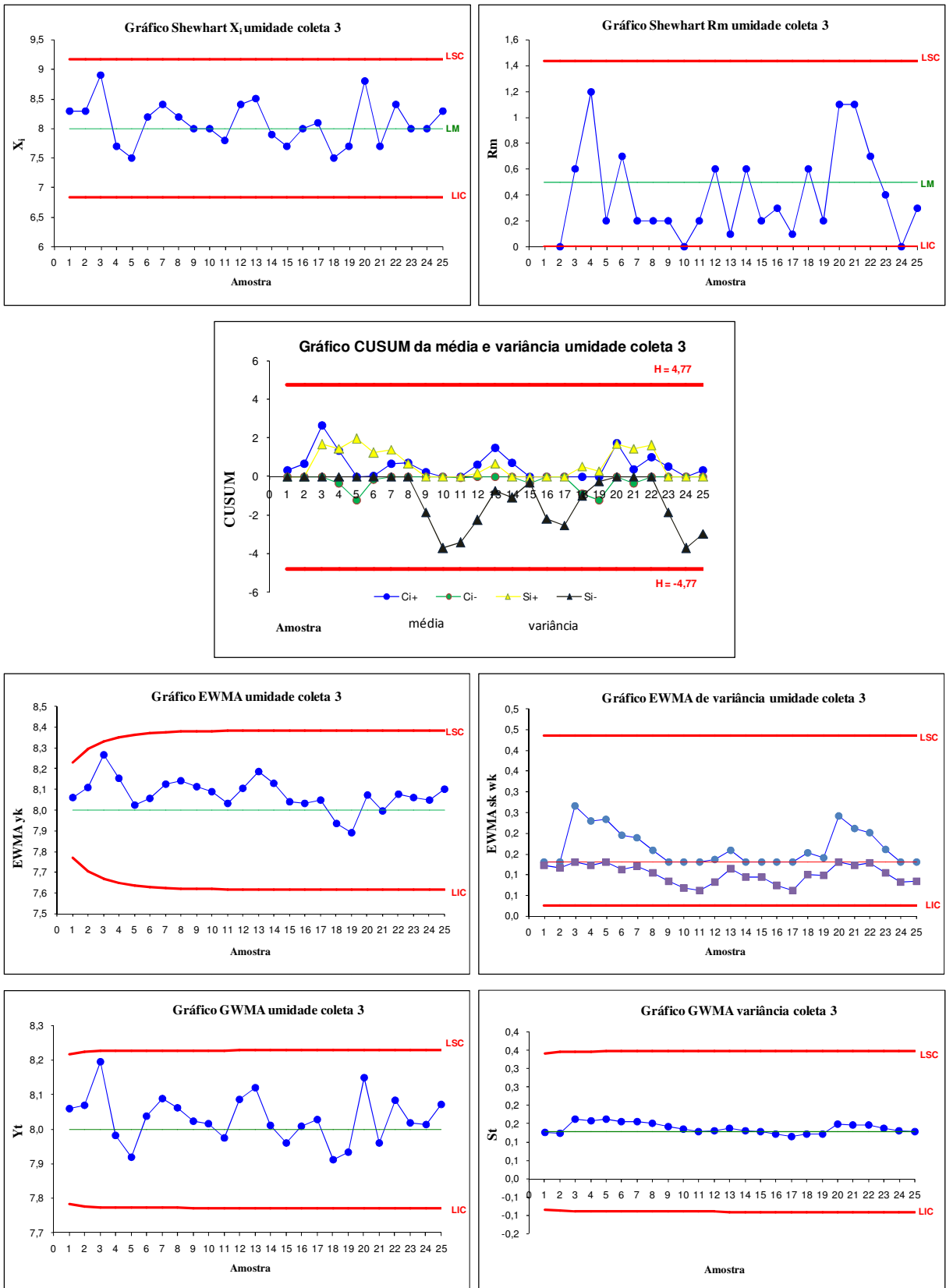
Figura 42 – Gráficos de controle umidade coleta 3
