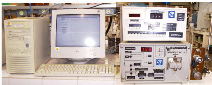
Figura 4. 3 - Cromatógrafo de fase líquida de alta eficiência – HPLC (LABMASSA, EQA/UFSC).
