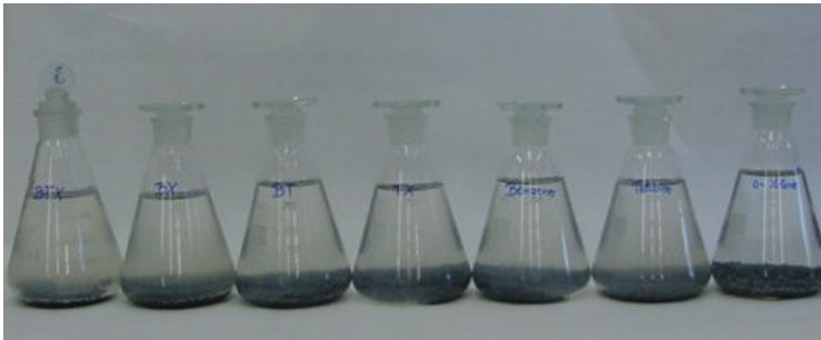
Figura 4. 2 – Biorreatores utilizados nos ensaios para obtenção das cinéticas.
