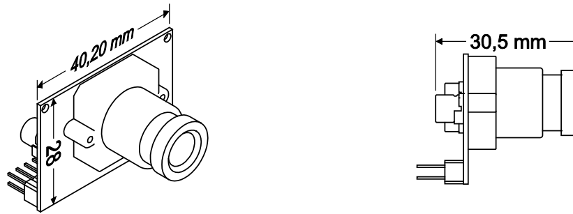
Figura 4.17 Sensor CMOS da câmera com lentes focais.
