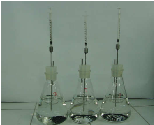
Figura 4. 2 - Aparato experimental utilizado para realização das cinéticas dos compostos BTX.
