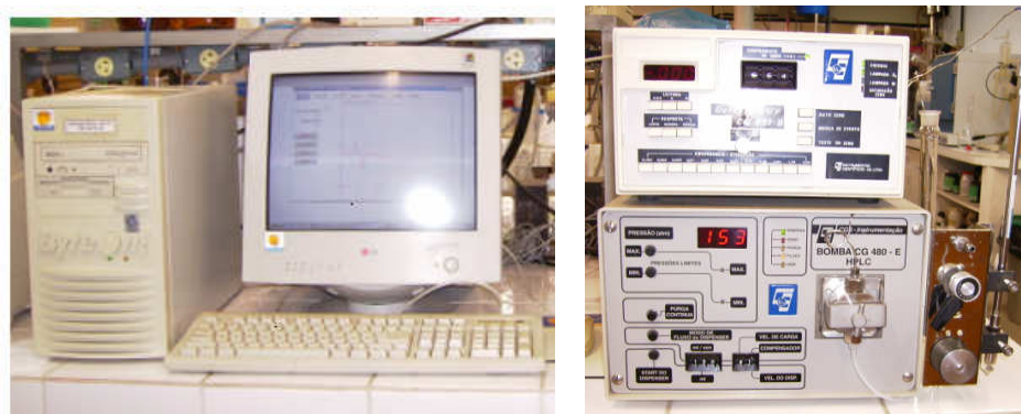
Figura 4. 1- Cromatógrafo de fase líquida de alta eficiência – HPLC (LABMASSA, EQA/UFSC).
