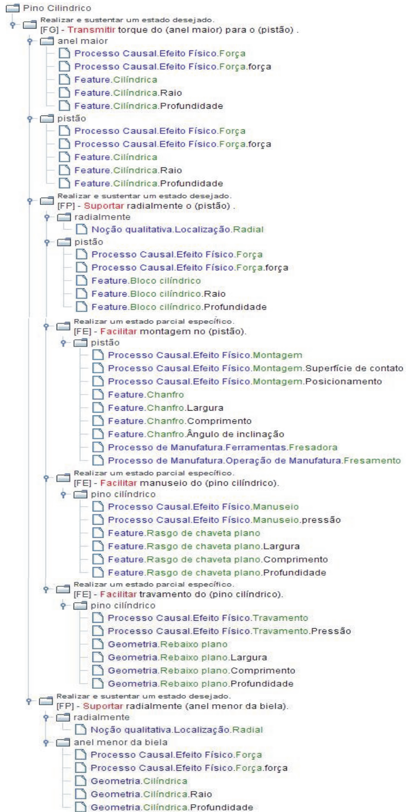
Figura 6-18: Árvore de funções, propósitos funcionais, processos causais (baseada em efeito físico, químico ou biológico) e feature das sentenças funcionais da peça pino cilíndrico 3
