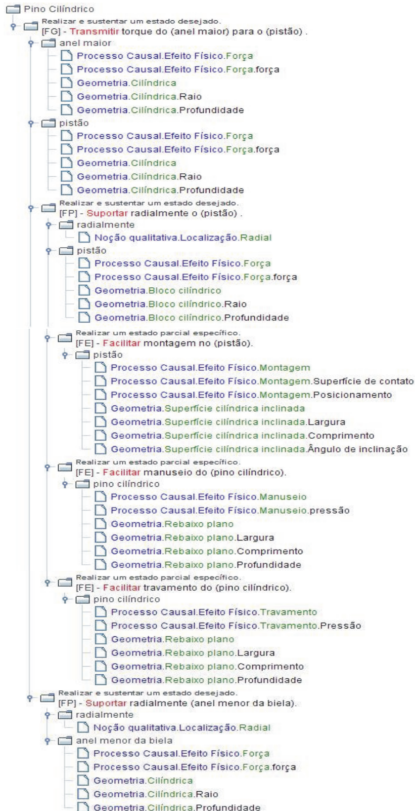
Figura 6-17: Árvore de funções, propósitos funcionais, processos causais (baseada em efeito físico, químico ou biológico) e geometrias das sentença funcionais da peça pino cilíndrico 3
