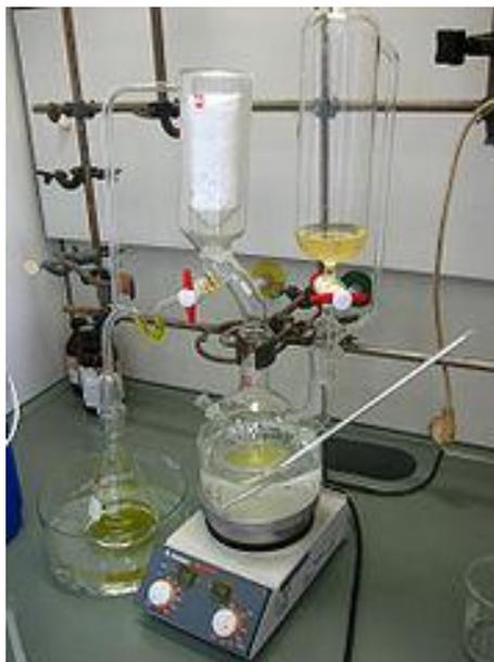
Figura 57 Obtenção do diazometano ( $\text{CH}_2\text{N}_2$ ).
