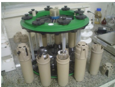
Figura 3.3 – Rotor do reator micro-ondas e frascos de quartzo.
