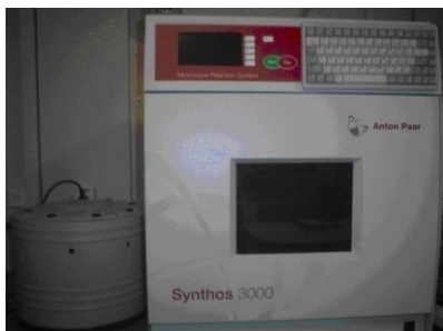
Figura 3.2 – Reator micro-ondas Synthos 3000, da Anton Paar.
