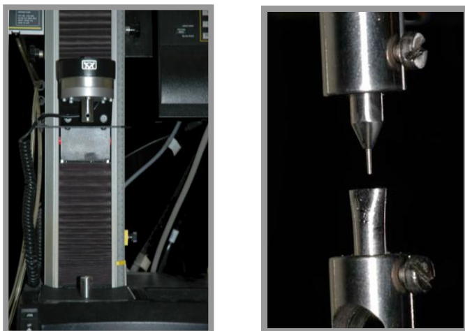
Figura 20 – a) Máquina Instron; b) pontas montadas.
