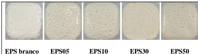
Figura 15 – Ilustração dos corpos de prova de poliestireno expandido com diferentes concentrações de aditivo oxidobiodegradável
