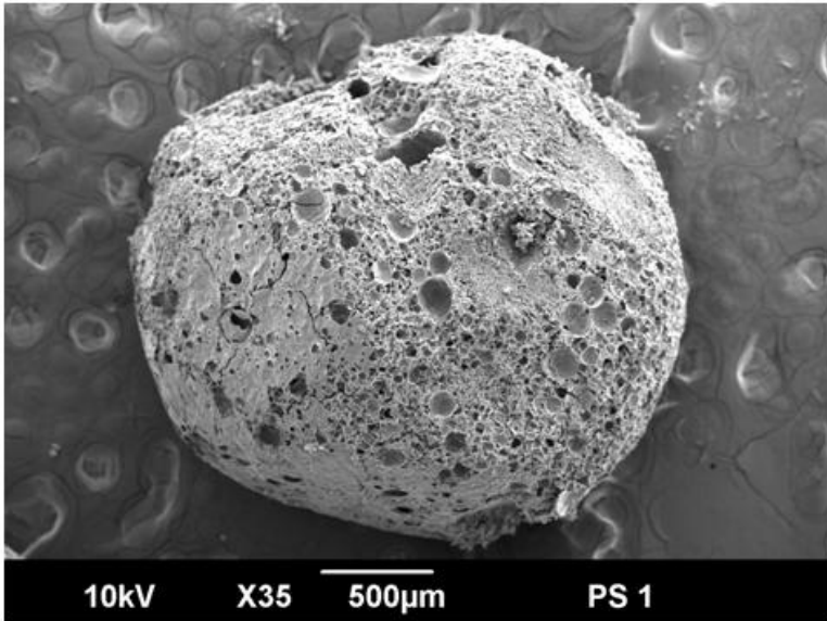
Figura 23 – Micrografia de uma pérola de EPS com 5% de aditivo e 15 dias envelhecimento
