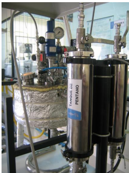
Figura 4 – Reator e a unidade de pentanização utilizados nas reações em suspensão
