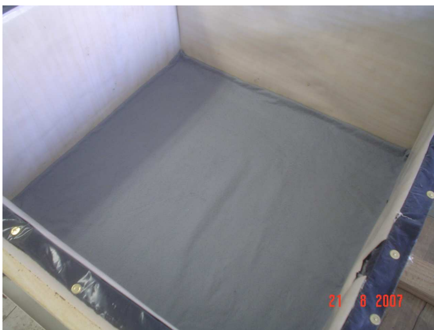
Figura 3.43 – Aplicação da manta geotextil entre as camadas de subleito e base.
