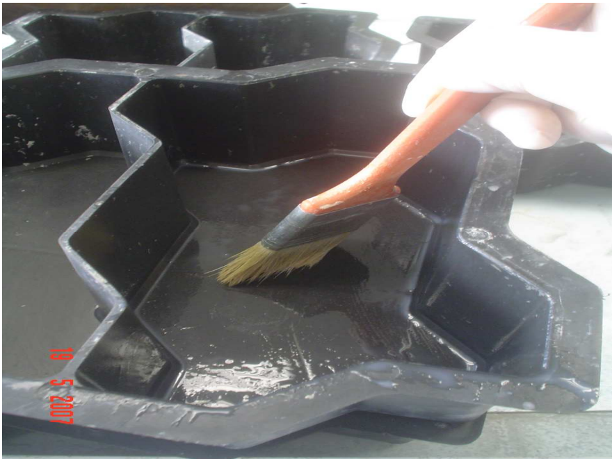
Figura 3.21 – Aplicação do desmoldante às formas dos blocos.
