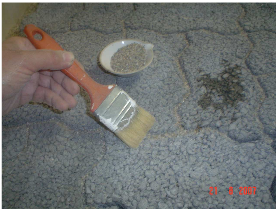
Figura 3.50 – Aplicação da areia estudada para material rejunte.
