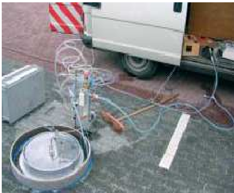
Figura 2.12 – Ensaio de infiltração baseado no método do duplo anel (Febestral, 2005).
