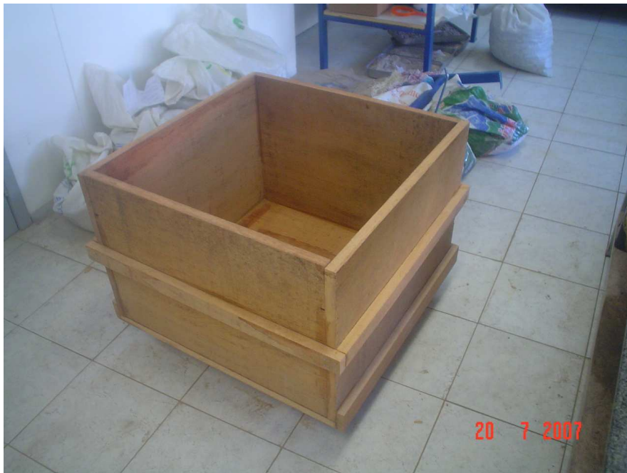
Figura 3.33 – Caixa do simulador de chuvas feita com pranchas de madeira.
