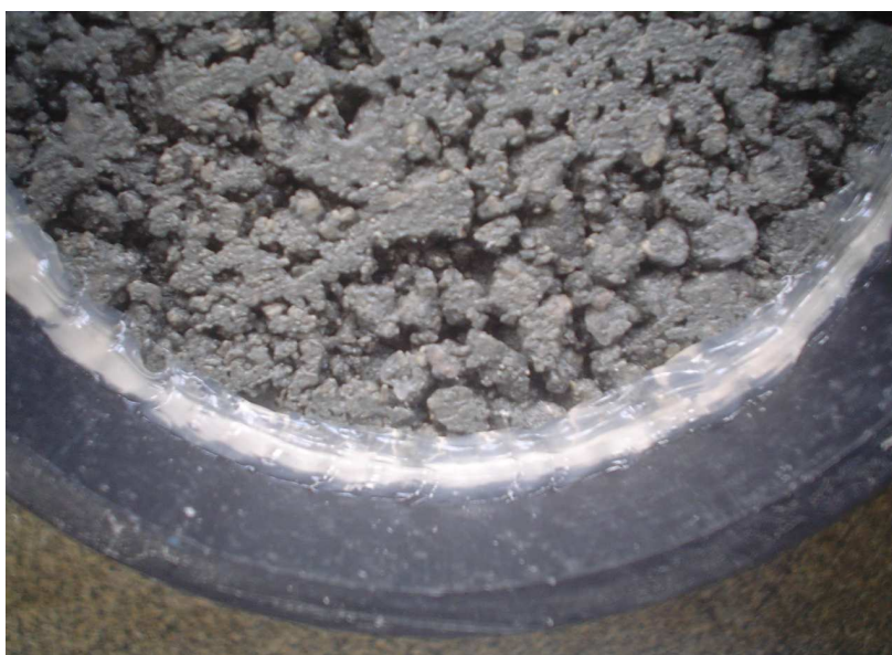
Figura 3.10 – Fixação e vedação com silicone
