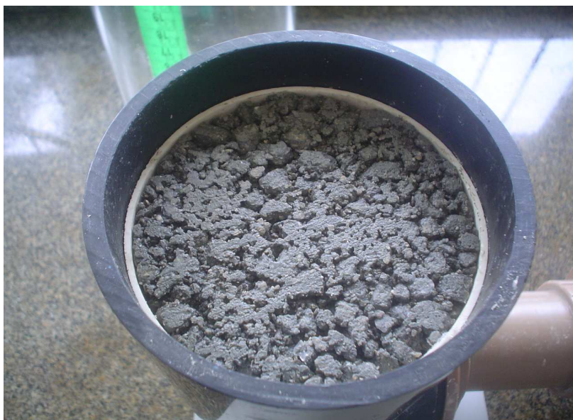
Figura 3.9 – Acoplamento do corpo de prova à base do equipamento
