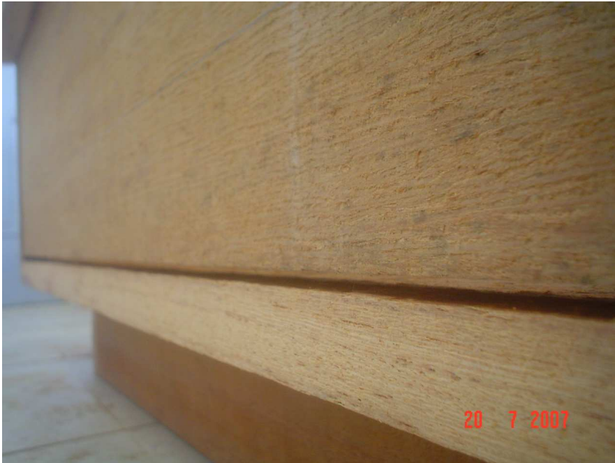
Figura 3.34 – Fenda de escoamento inferior da caixa do simulador.
