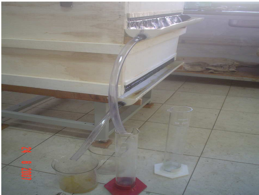
Figura 3.35 – Calhas laterais do simulador para coleta de escoamento e infiltração.
