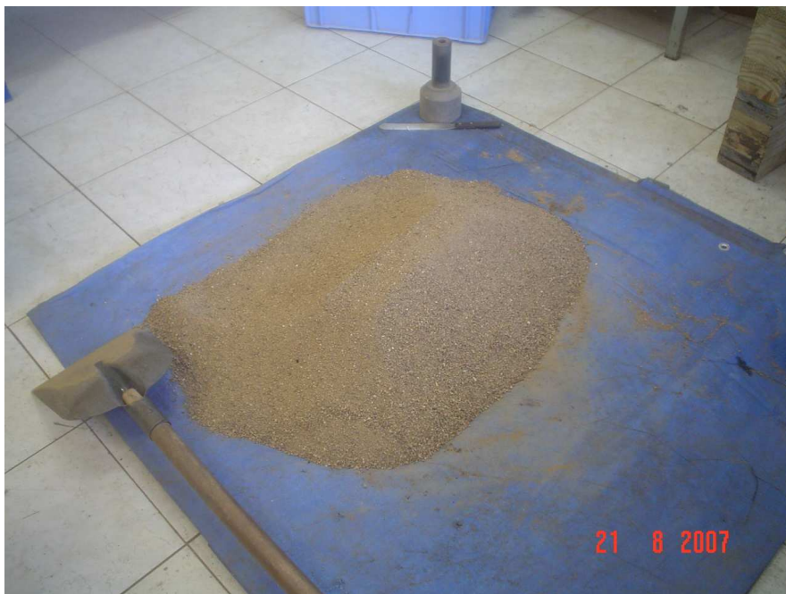
Figura 3.40 – Material coletado e usado como camada de Subleito.
