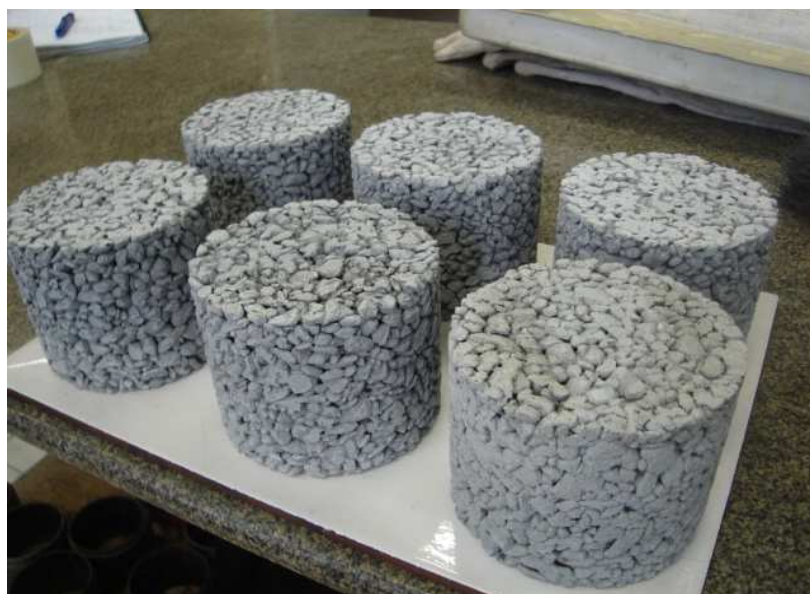
Figura 3.16 – Corpos de prova moldados com a curva granulométrica adotada
