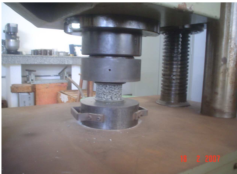
Figura 3.15 – Ruptura por compressão do corpo de prova
