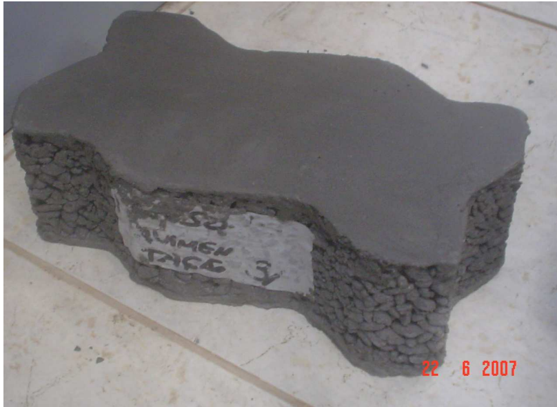
Figura 3.27 – Bloco capeado, pronto para ruptura à compressão.
