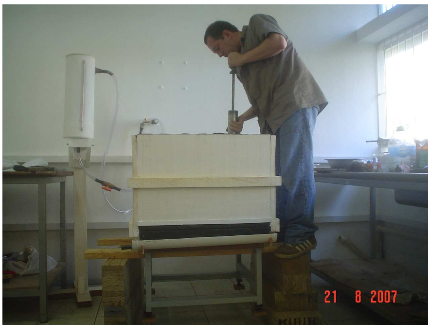
Figura 3.41 – Compactação da camada do Subleito.
