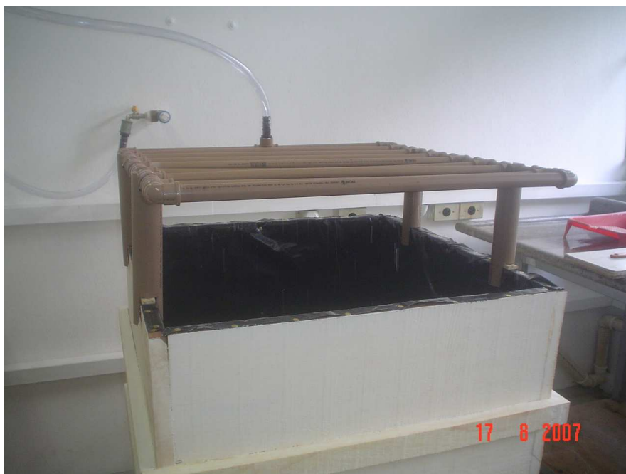
Figura 3.36 – Grelha em tubos de PVC de ½”.
