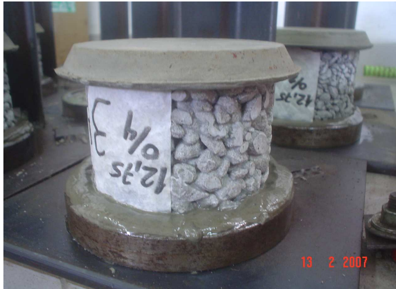
Figura 3.14 – Capeamento do corpo de prova com argamassa
