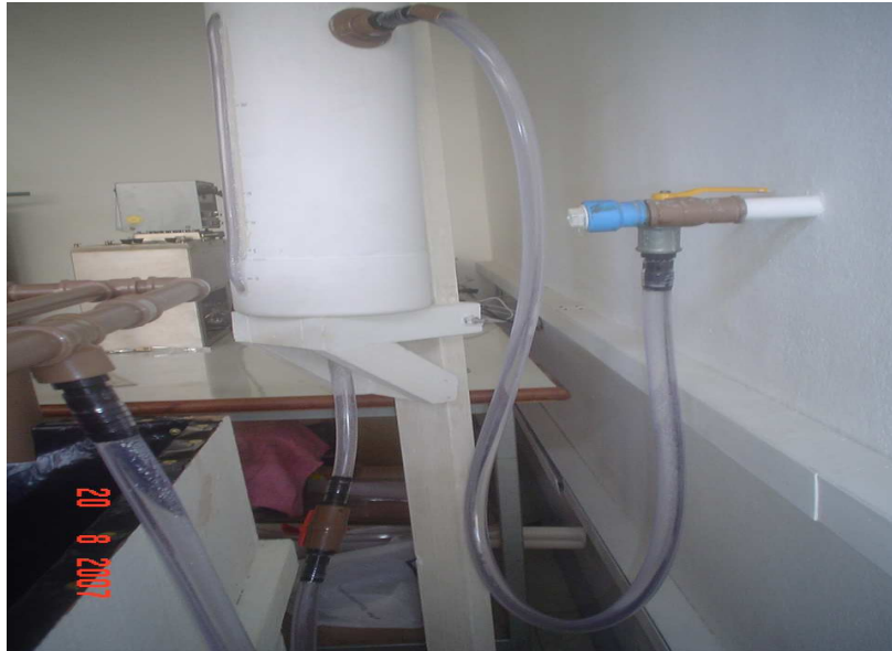
Figura 3.38 – Conexão dos tubos ao reservatório de água do simulador.
