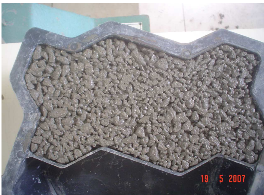
Figura 3.25 – Superfície do bloco após a vibração.
