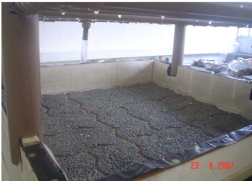
Figura 3.54 – Simulação da chuva de 79,1mm/h.
