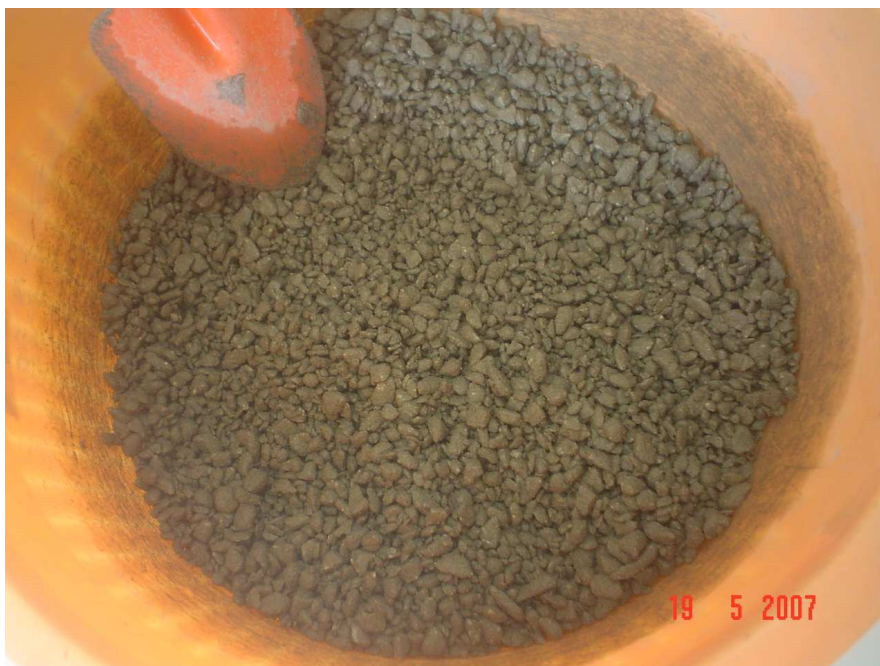
Figura 3.22 – Preparação da mistura para moldagem do bloco
