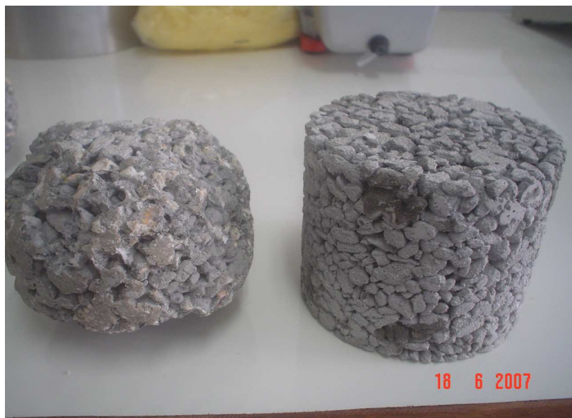
Figura 3.19 – Corpo de prova após realização do ensaio Cántabro.
