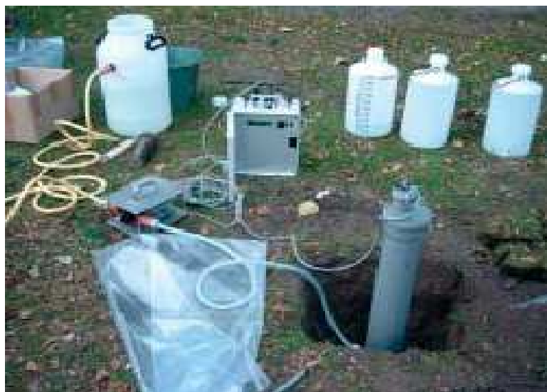
Figura 2.7 – Permeabilidade “in situ” ( Open-end-test ) (Febestral, 2005).
