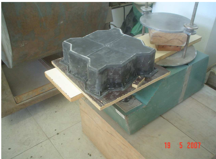
Figura 3.24 – Moldagem do bloco por meio de vibração da forma.
