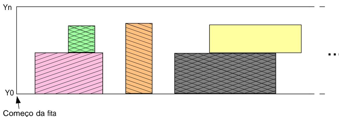
Figura 3.2: Algoritmo de empacotamento em fita.
