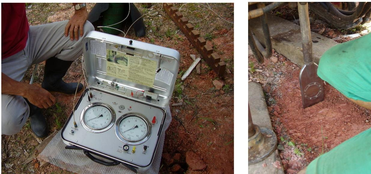
**FIGURA 9 – Fotos da unidade de controle (esquerda) e da lâmina penetrando no solo (direita)**
