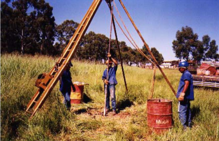
**FIGURA 30 – Foto da execução do ensaio SPT**
