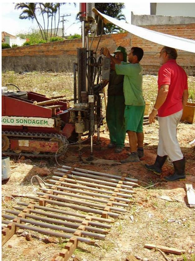
**FIGURA 12 - Foto da preparação do ensaio DMT**
