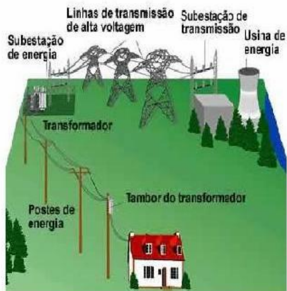
Figura 2 - Rede de distribuição de energia elétrica
