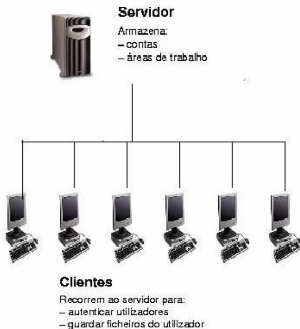
Figura 1 - Rede baseada numa estrutura cliente-servidor
