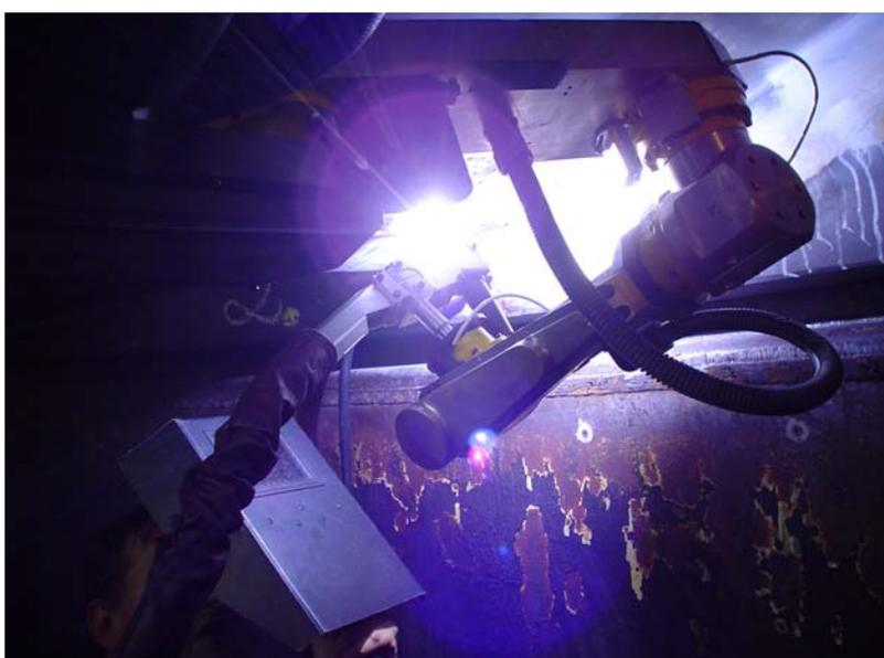
Figura 50: Soldagem Automática com Roboturb.
