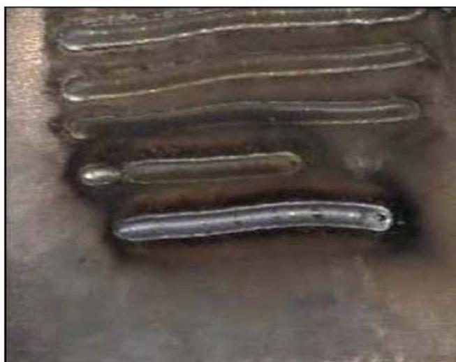
Figura 46: Resultados do Processo de Soldagem MIG com Roboturb.
