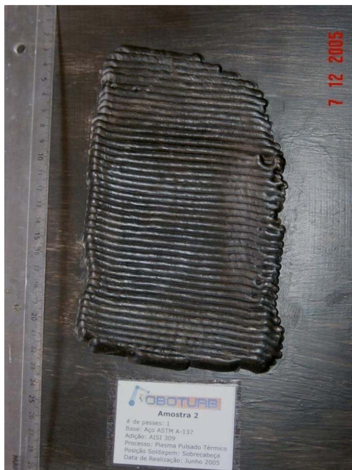
Figura 48: Resultado da Recuperação de uma cratera com o Roboturb.
