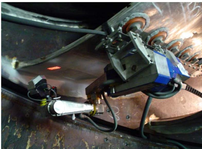
Figura 49: Medição Automática com Roboturb.
