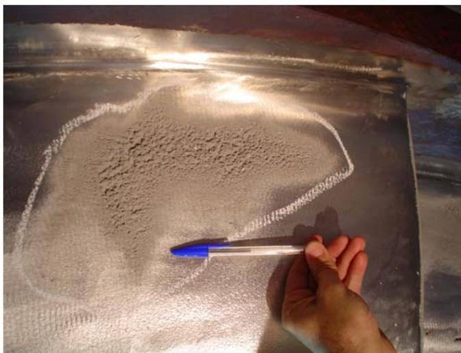
Figura 5: Região erodida por cavitação.
