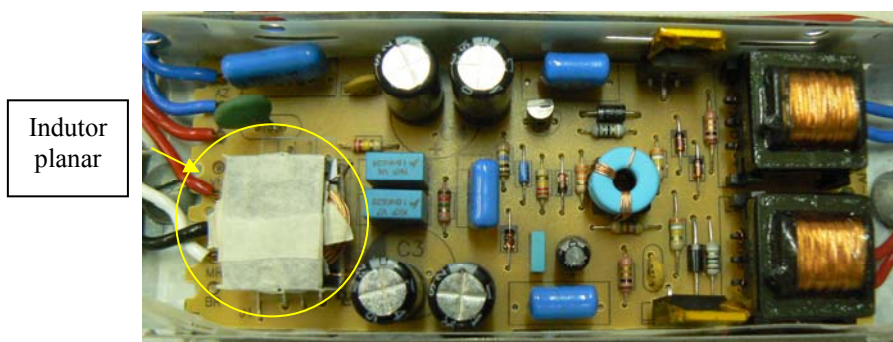
Fig. A5.3 – Reator eletrônico com o indutor planar
