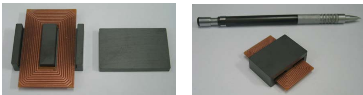
Fig. 4.8 - Elemento magnético utilizando o núcleo E-PLT 38.
