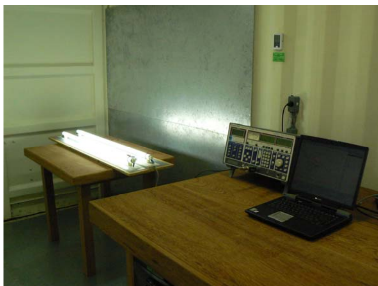
Fig. A5.11 – Configuração de teste de EMI conduzida para reator eletrônico.
