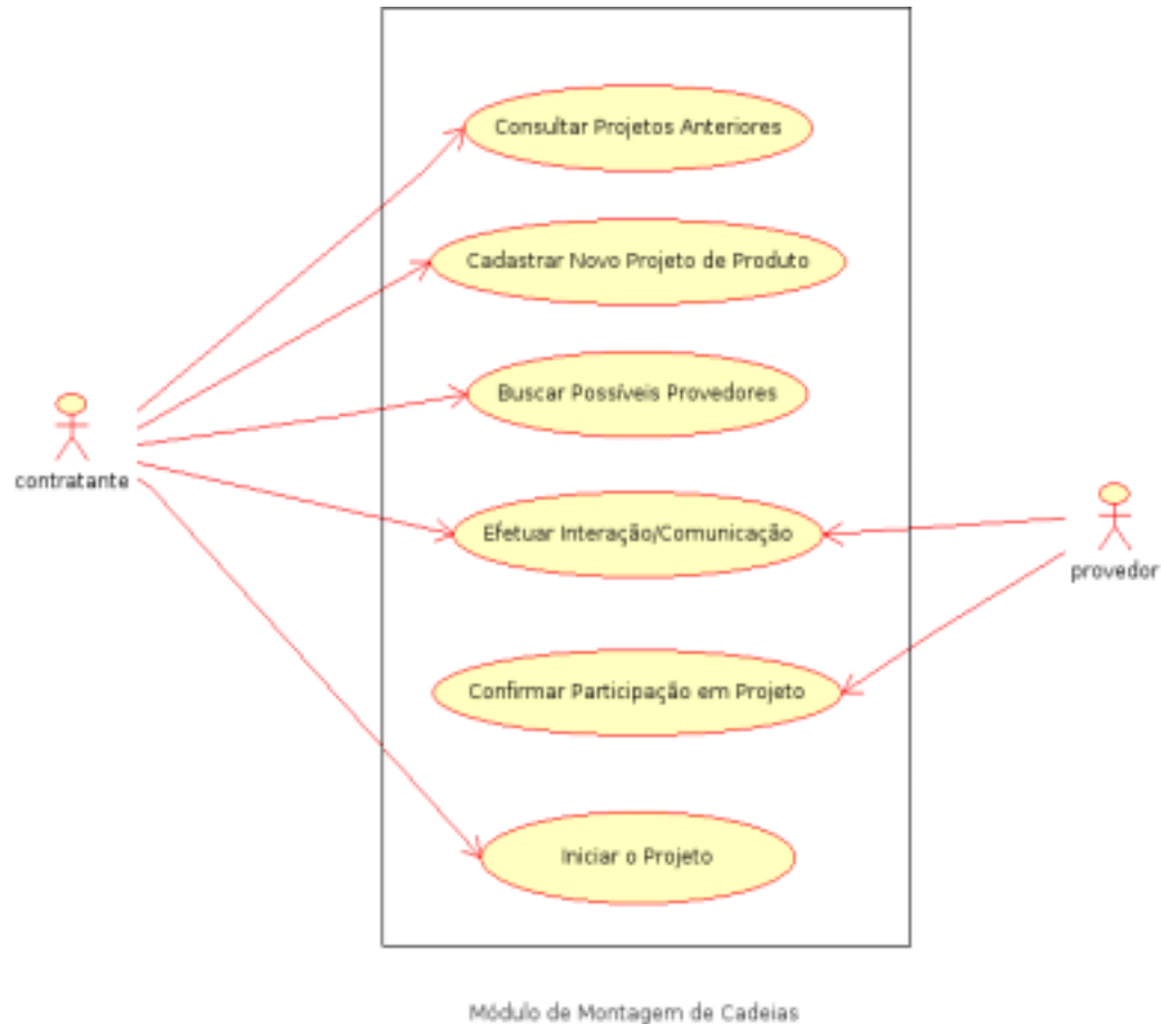
Figura 31 - Diagrama UML do Módulo de Montagem de Cadeias. Fonte: Autor.
