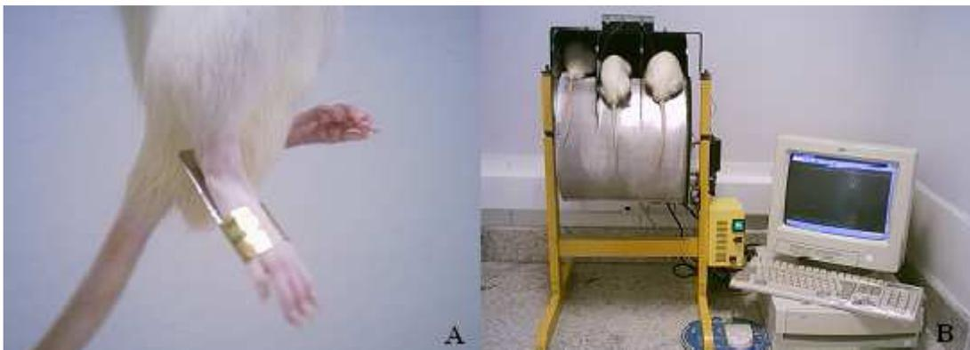
**FIGURA 7:** (A) Ratas com as sapatilhas metálicas e (B) cilindro de aço inox utilizado na determinação da incapacitação articular através da medida do tempo de elevação da pata (TEP,s).
