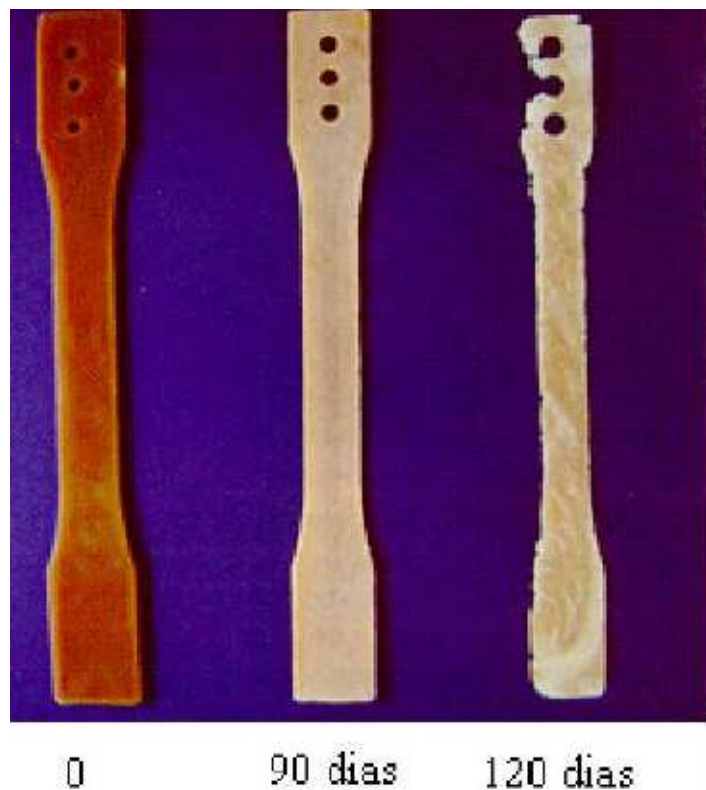
Figura 2.13 - Corpo de prova produzido com P(3HB) em decomposição em fossa séptica.
