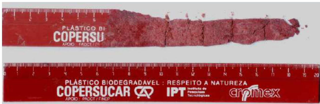
Figura 2.12 - Régua produzida a partir de P(3HB) em processo de biodegradação.
