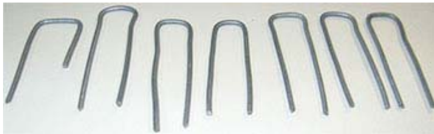
Figura 6: Grampos de arame para fixar os componentes à base do tabuleiro.
