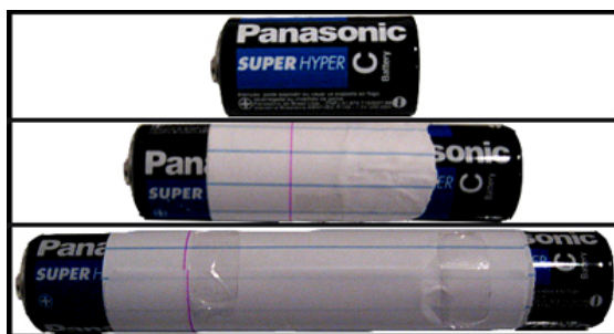
Figura 18: Pilhas conectadas em série envoltas numa folha de papel.
