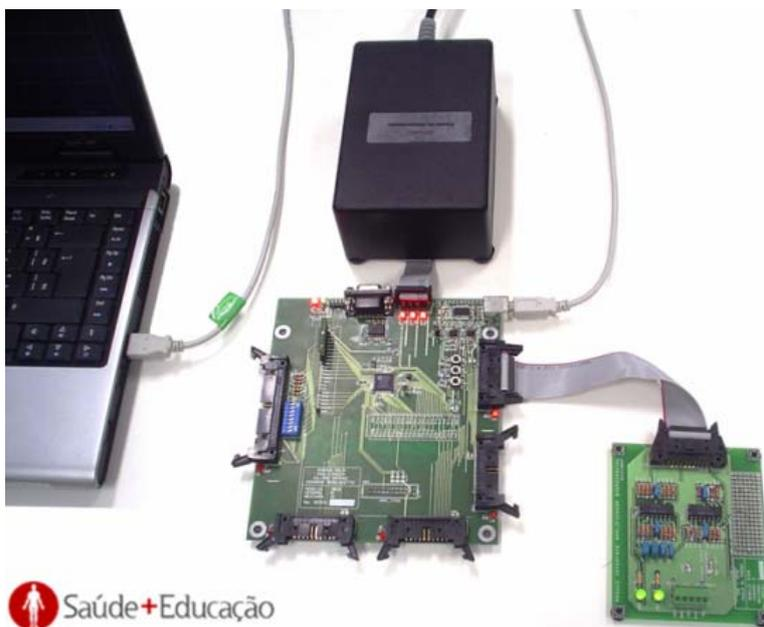
**Figura 4.17** – Como devem ficar as conexões entre os módulos utilizados nesta prática.
