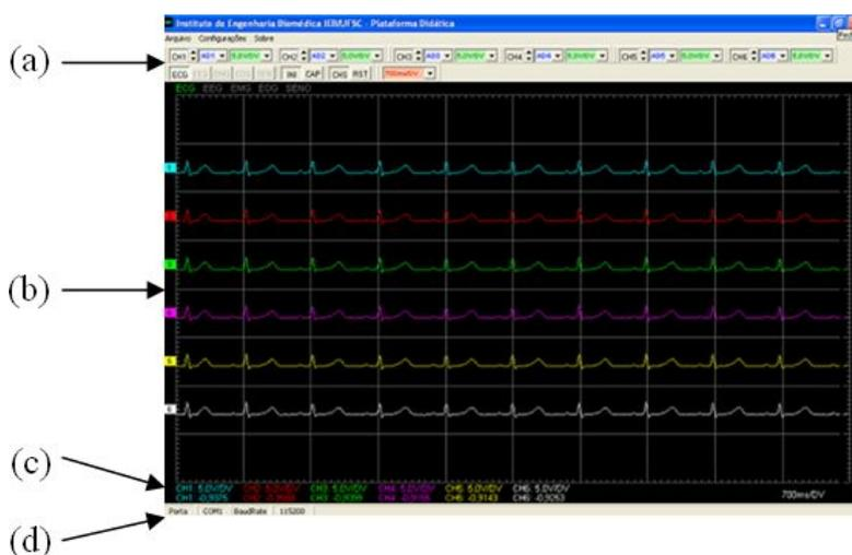
**Figura 4.23** - Exemplo de visualização simultânea dos seis primeiros canais do ADC na aquisição do ECG simulado pelo MB: (a) barra de ferramentas; (b) gráfico; (c) leitura de valores instantâneos; (d) barra de status.
