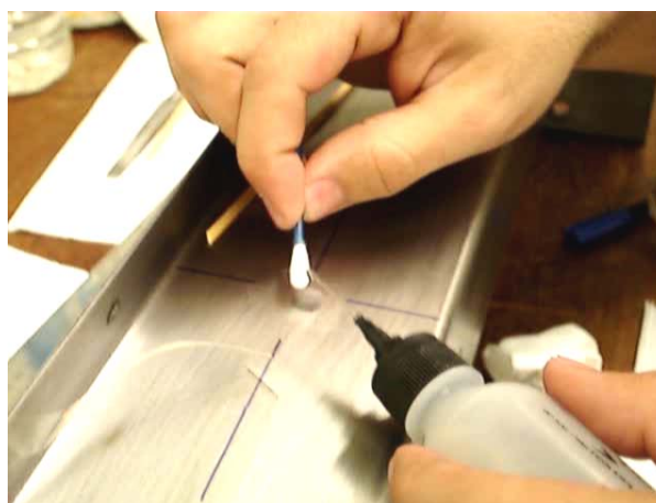
Figura A4.3 - Limpeza da região onde o extensômetro foi fixado
