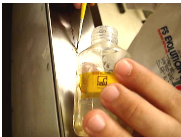
Figura A4.8 – Aplicação do esmalte de proteção no extensômetro.
