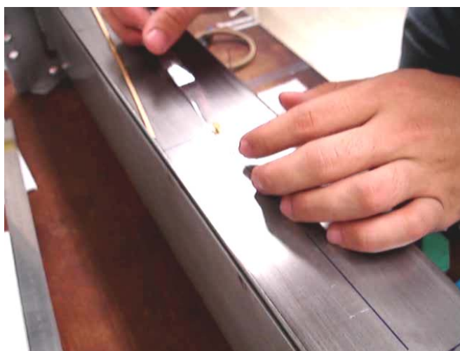
Figura A4.5 – Posicionamento do extensômetro antes da colagem
