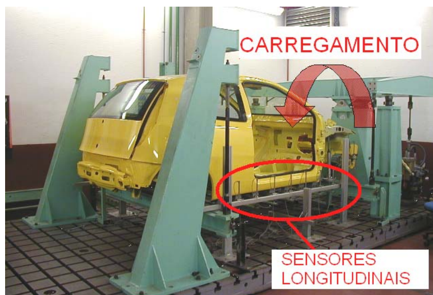
Figura 3.4 - Ensaio de torção experimental padrão da FIAT.
