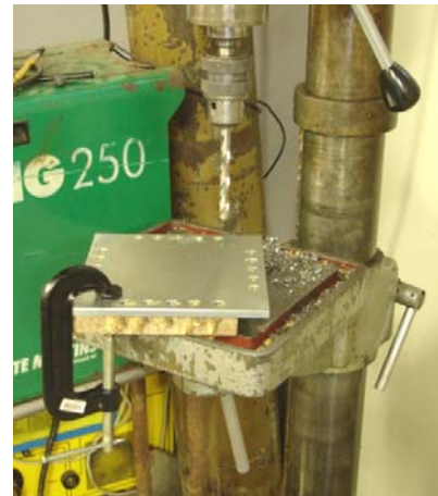
Figura 4.4 – Alargamento dos furos das placas.
