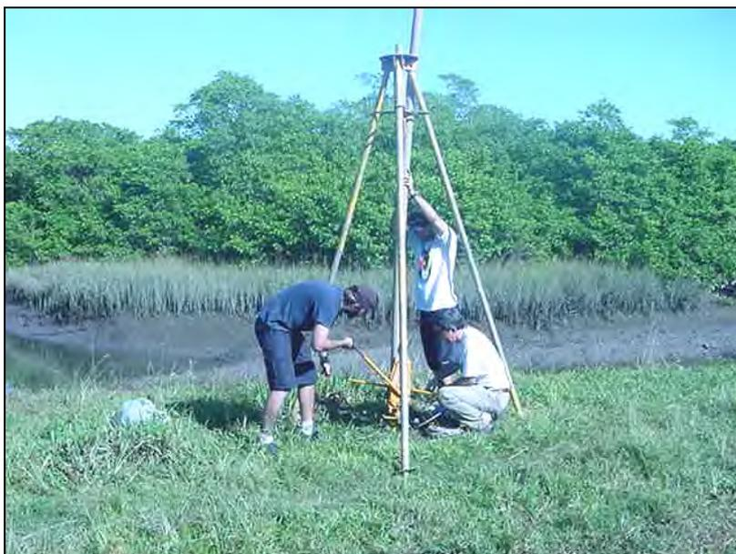
Figura 20 – Coleta de sedimentos em subsuperfície com o auxílio de testemunhador à percussão.
