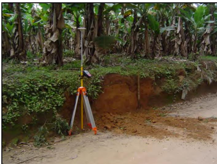
Figura 21 – Utilização do DGPS para a coleta de cotas altimétricas.
