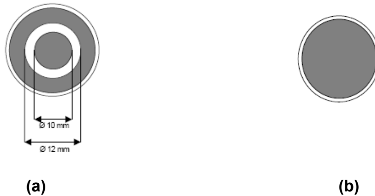
Figura 18. Geometria das amostras preparadas para medidas de constante dielétrica e tangente de perda: (a) vista superior da amostra, (b) vista inferior da amostra [10].
