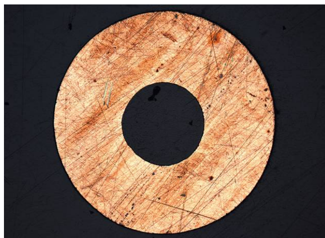
Figura 61 – Seção transversal do tubo capilar ampliada 50 vezes
