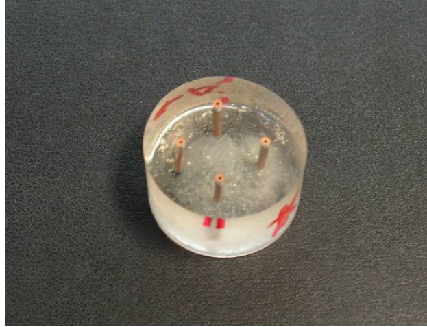
Figura 60 – Amostra embutida e polida
