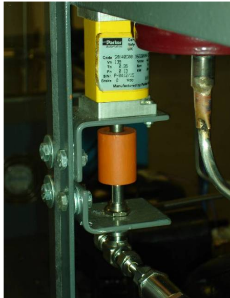
Figura 19 – Válvula e servomotor empregados no controle da pressão de alta
