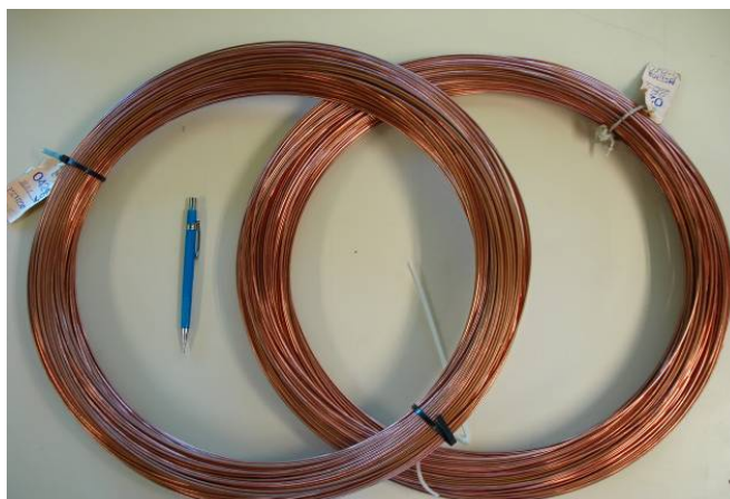
Figura 11 – Tubo capilar de cobre
