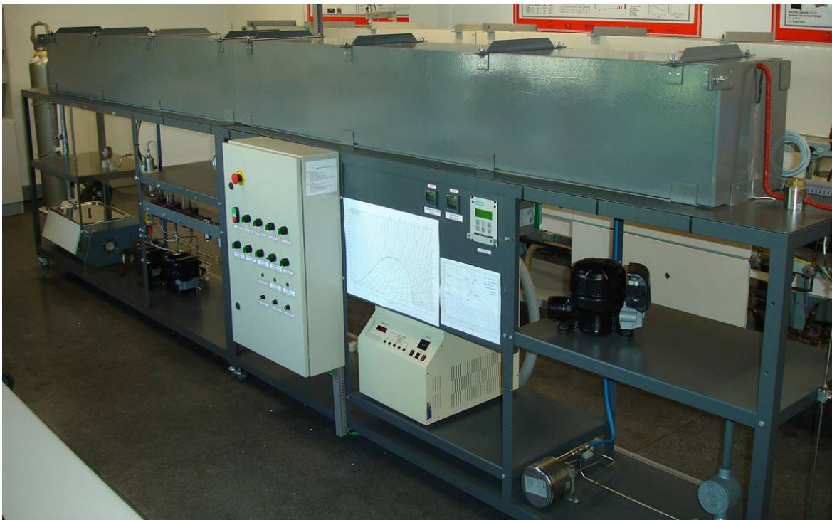
Figura 15 – Foto da bancada experimental de tubos capilares adiabáticos para o escoamento de R-744
