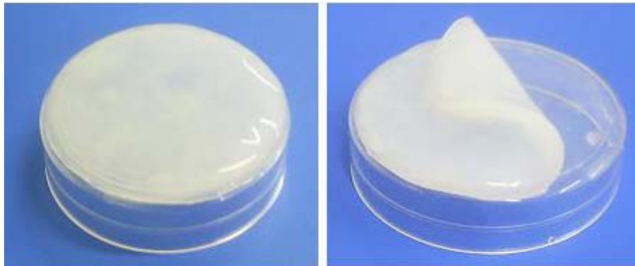
Figura 4.2 – Membrana de hidrogel de CB produzida por G. hansenii em condições estáticas.
