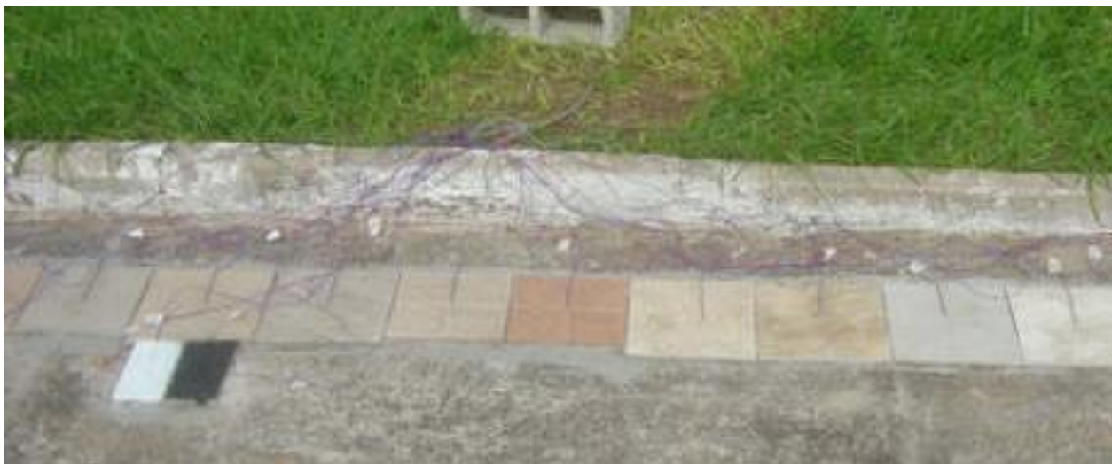
Figura 11 - Medição da temperatura da superfície dos pisos através de termopares.
