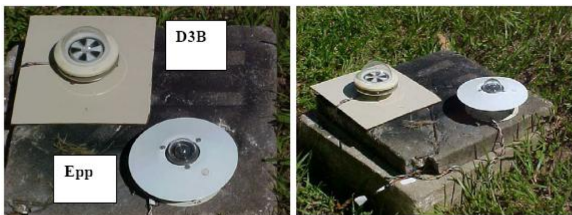
Figura C.3 – Piranômetro Epp utilizado para calibrar o piranômetro D3B.
