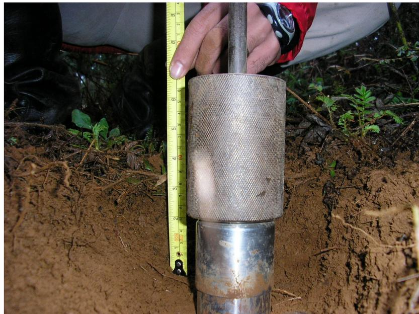
Figura 21 – Coletor de anéis volumétricos usado na determinação da densidade do solo.
