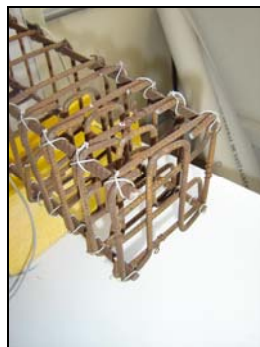
Detalhe da armadura de fretagem do pilar.
