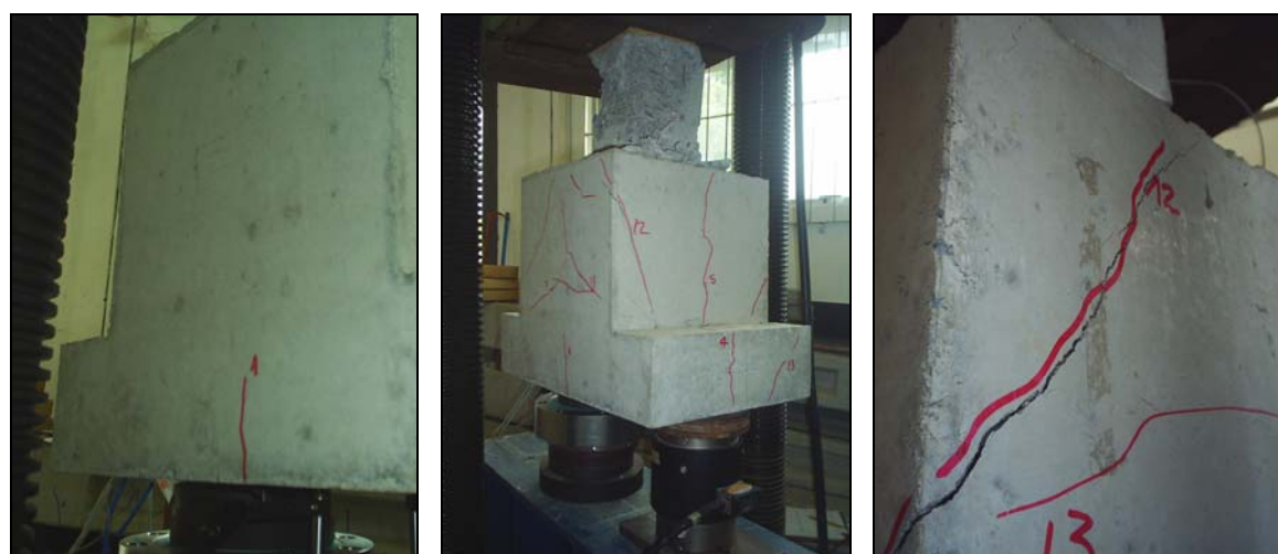
Figura 4.7 – Fissuras apresentadas no Modelo C2.
