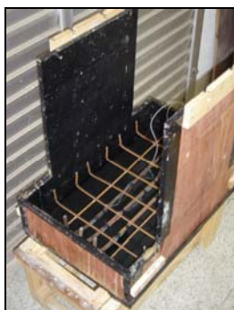
Armadura da base do bloco.
