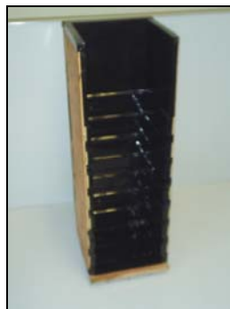
Fôrma do pilar com chaves de cisalhamento.
