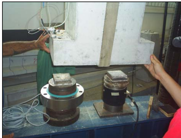
Figura 3.31 – Colocação do bloco sobre as estacas metálicas.
