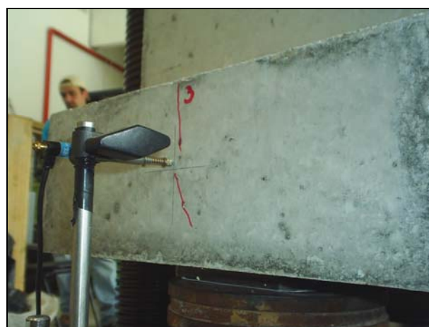
Figura 3.27 – LVDT – medidas horizontais.
