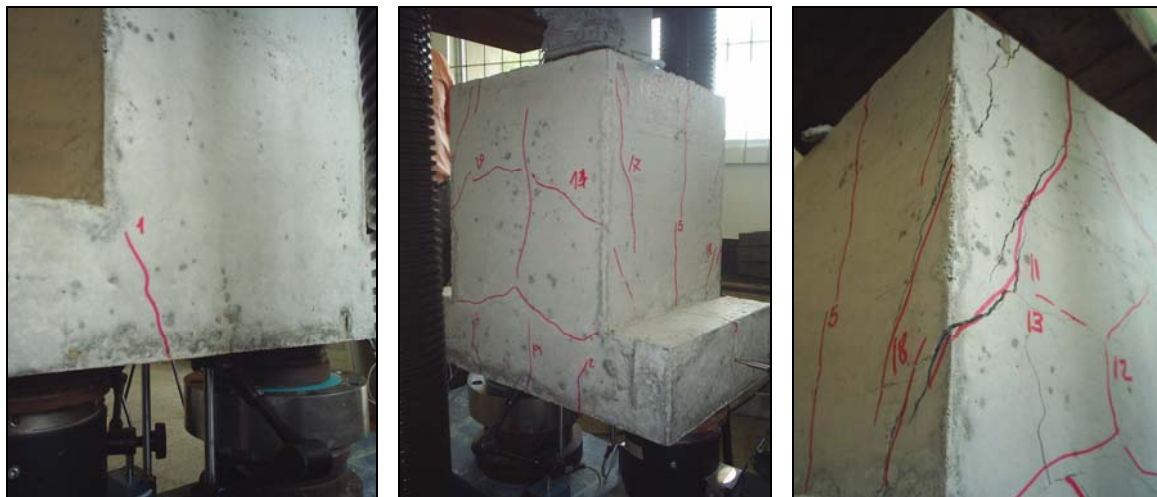
Figura 4.6 – Fissuras apresentadas no Modelo C1.
