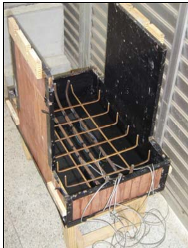
Figura 3.23 - Detalhe da armadura principal de tração.
