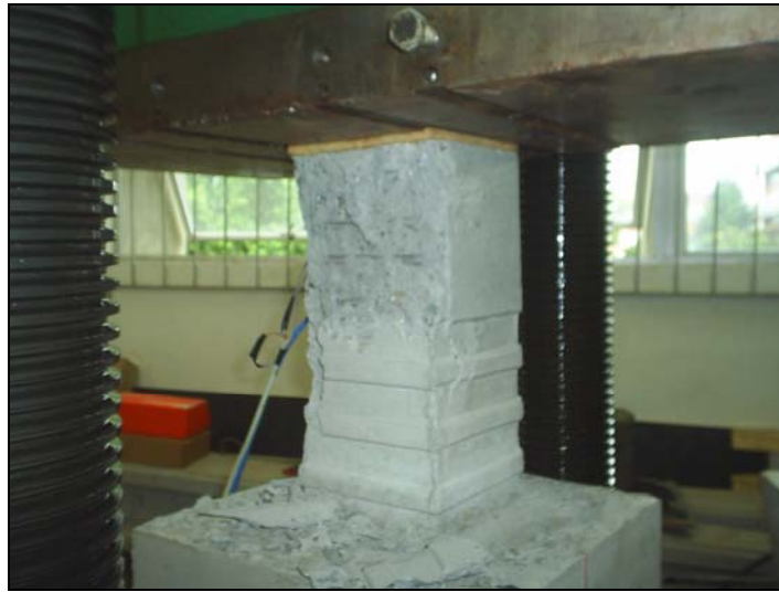
Figura 4.2 – Ruína do cobrimento do pilar (Modelo C3).
