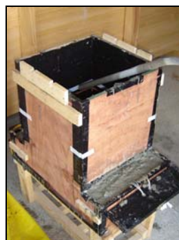
Coconcretagem da base do bloco.
