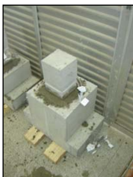
Concretagem da junta preenchimento.
