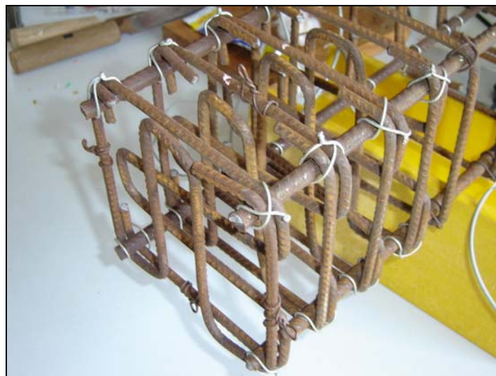
Figura 3.5 – Detalhe da armadura de fretagem.
