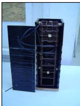
Montagem da armadura do pilar.
