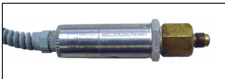
Figura 53: Transdutor de pressão utilizado no circuito de refrigerante
