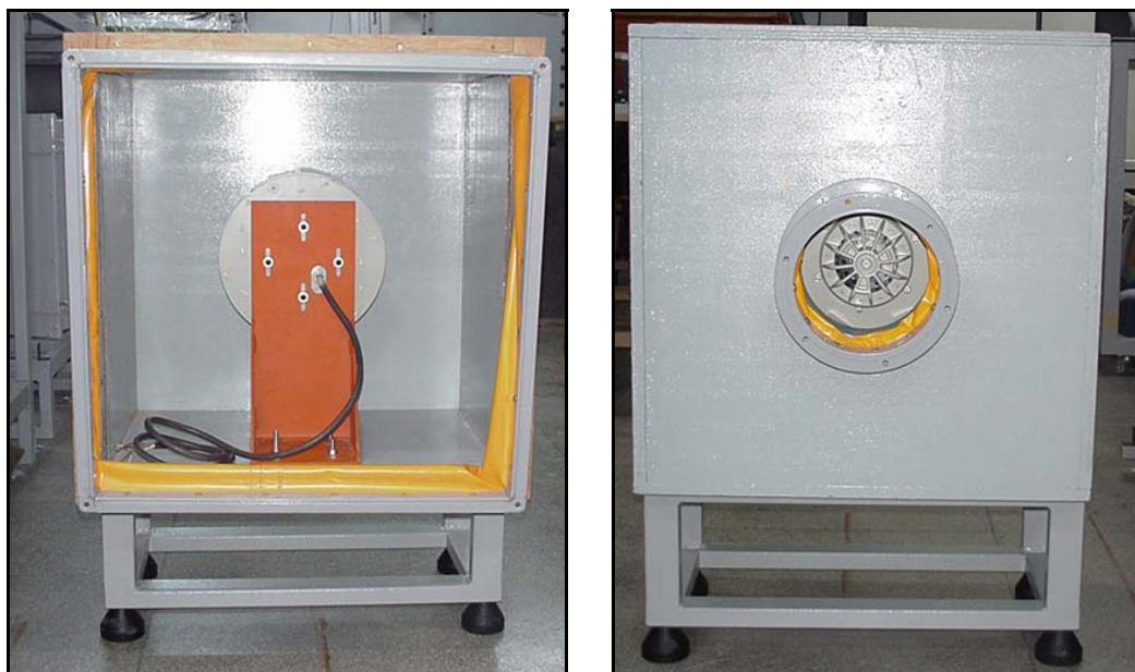
Figura 37: Montagem do ventilador radial
