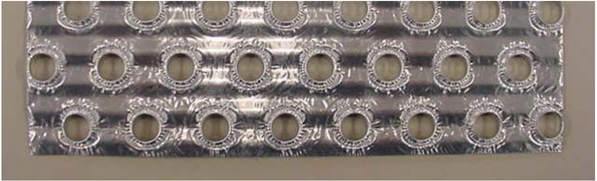
Figura 123: Aleta wavy sem louver e com borda lisa
