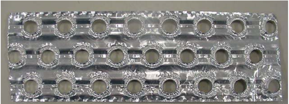
Figura 127: Aleta wavy com louver e com borda corrugada
