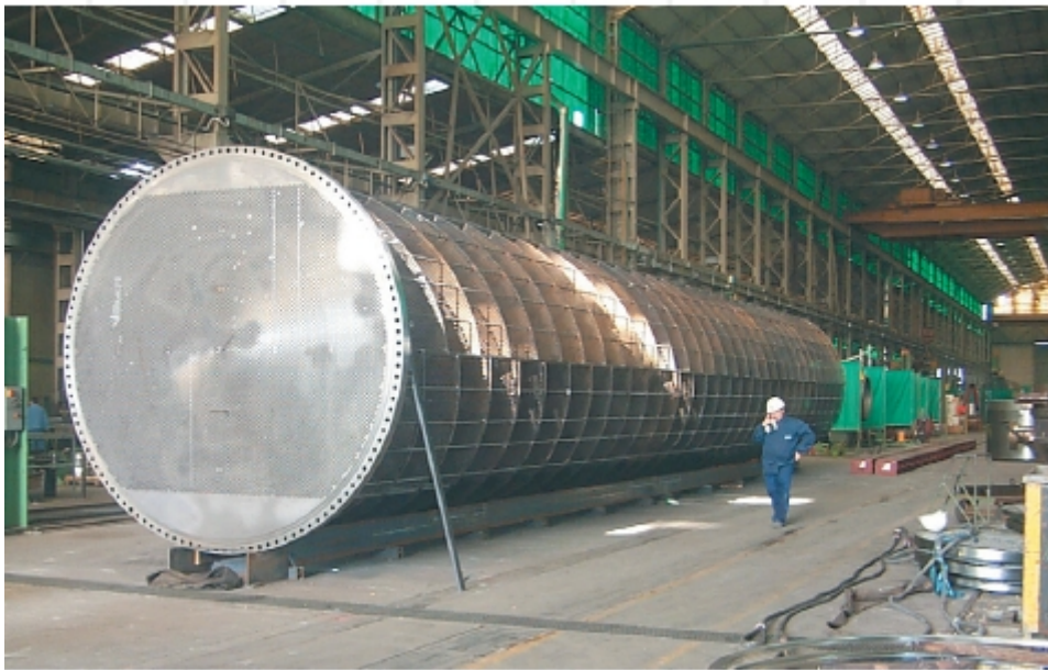
Figura 2: Trocador de calor compacto utilizado em processos industriais
