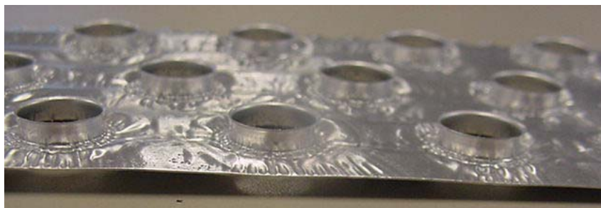
Figura 124: Aleta wavy sem louver e com borda lisa
