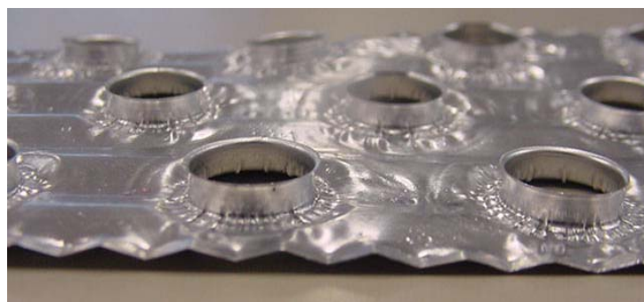
Figura 126: Aleta wavy sem louver e com borda corrugada
