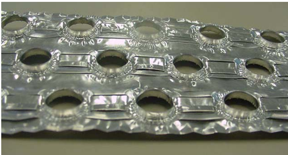
Figura 128: Aleta wavy com louver e com borda corrugada
