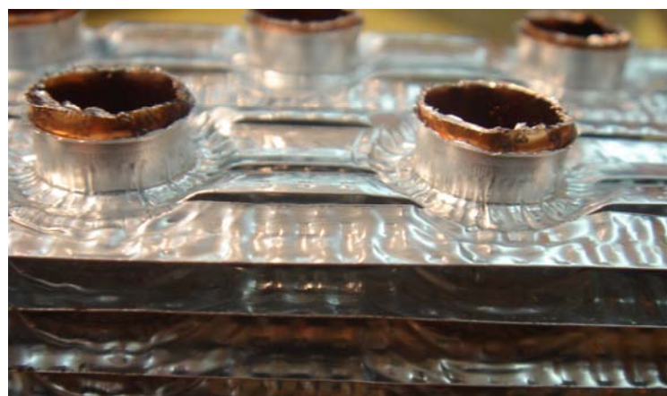
Figura 132: Aleta piramidal com louver e com borda lisa
