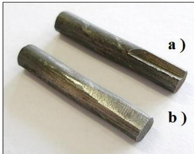
Figura 3.5 – Vista dos dois tipos de varões de aço, a) Varão com chanfro (P.11), b) Varão facejado (P.12)
