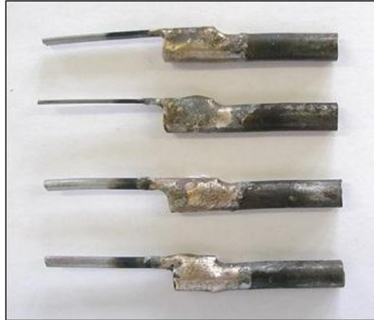
Figura 3.6 – Provetes de aço/NiTi brasados com liga de 20 % Ag (P.6, P.7, P.4, P.5)
