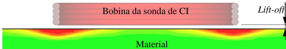
Figura 2.11 – Representação qualitativa da intensidade e localização das CI produzidas por uma bobina helicoidal cilíndrica com 4 espiras (vista de corte) [33]
