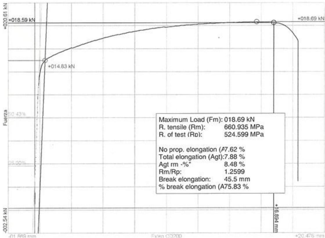
Figura 3.1 - Curva Força/Deformação do aço
