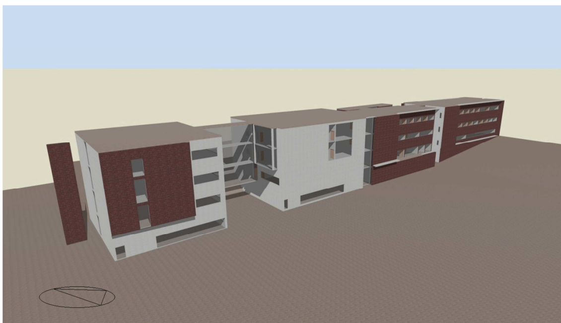
Figura 4-4: Vista detalhada do modelo representativo do Ed.VIII, com a função “visualize” do DesignBuilder.
