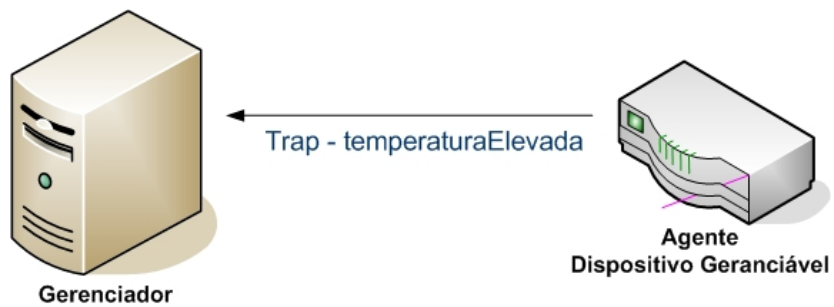
Figura 3.7: Exemplo SNMP trap
