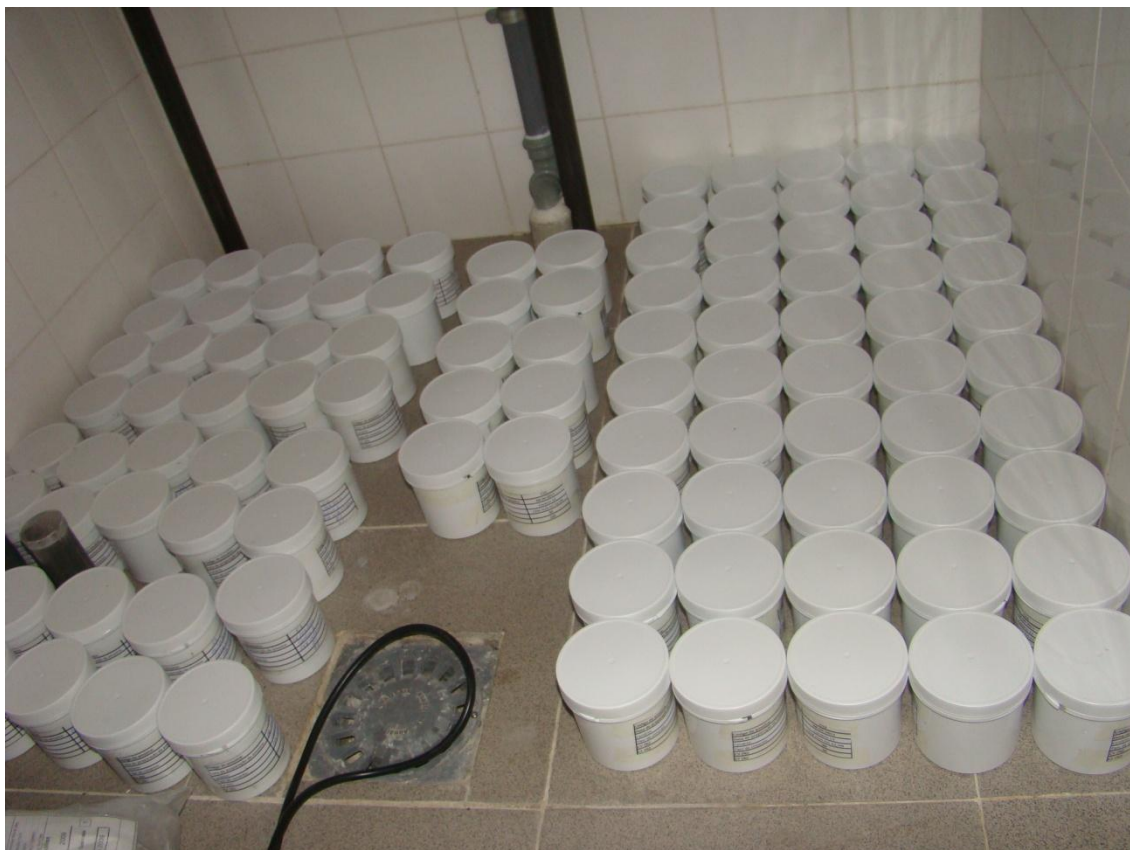
Figura 2.7 – Provetes de plástico contendo os betões produzidos, em fase de maturação
