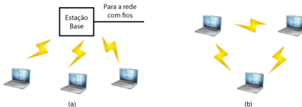
Figura 2.1: (a) Rede sem fios com ponto de acesso. (b) Rede Ad-hoc. [Tanenbaum and Wetherall, 2010]
