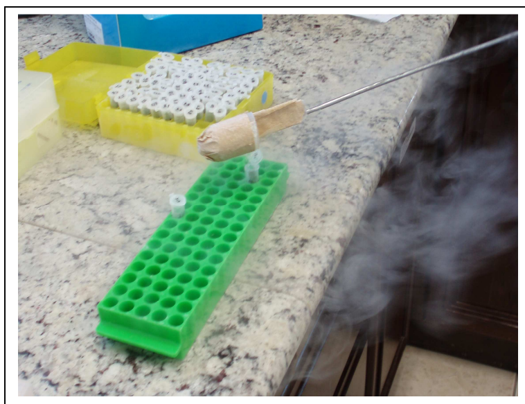
Figura 12. Congelamento de folhas de arroz com nitrogênio líquido.
