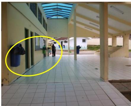
Figura 75. Elementos ordenados (lixeiras e bebedouro), situados na rota que leva ao refeitório (sem sinalização tátil de alerta).
