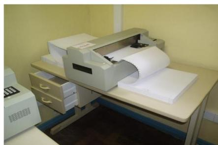
Figura 20. Máquina para impressão em Braille.
