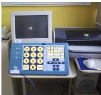
Figura 10. Computador com teclado ampliado para alunos com restrições visuais (e motoras).
