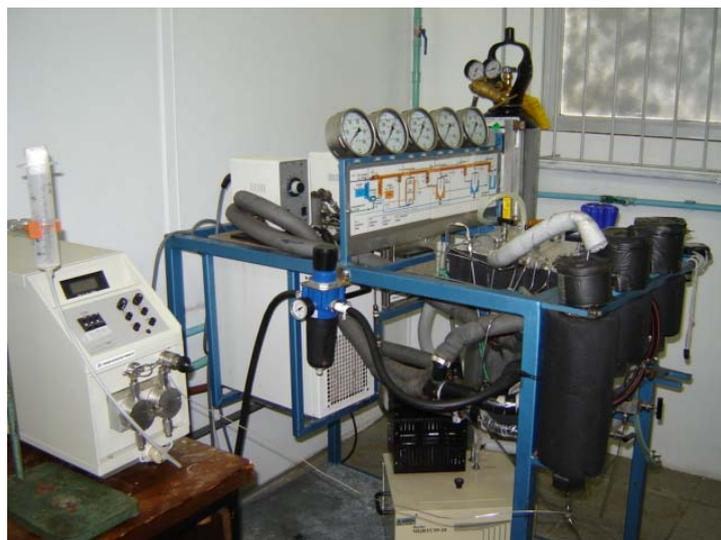
*Figura IV - Equipamento de extração 2, acoplado a bomba de co-solvente.*
