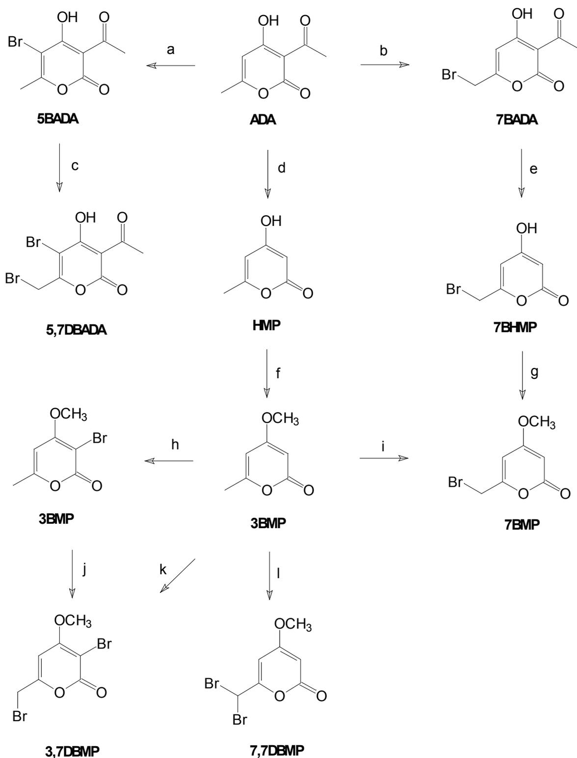
Figura 14 – esquemas para as reações de bromação envolvendo o ácido dehidroacético e o composto MMP.
