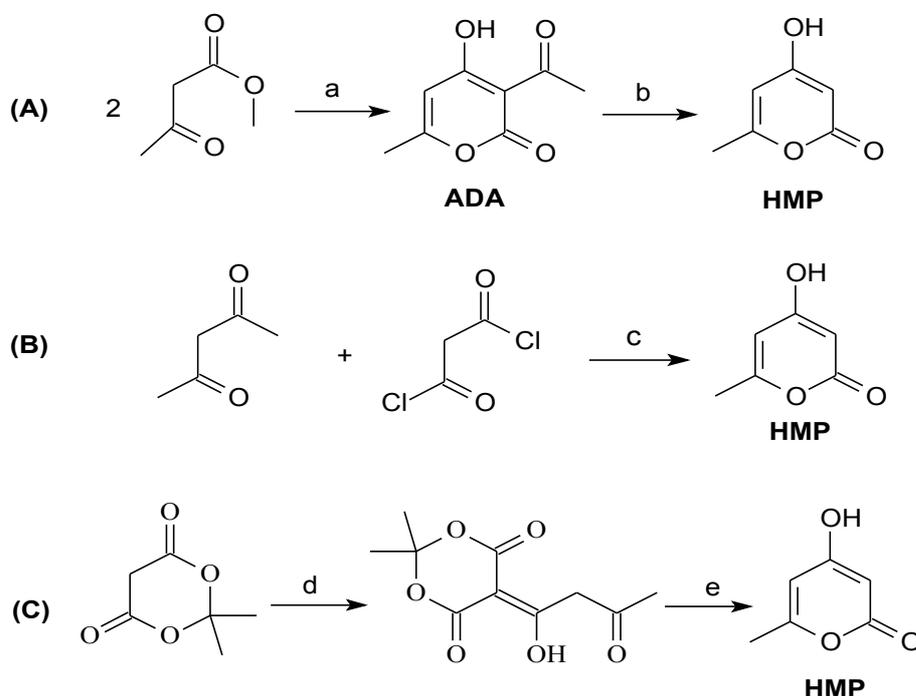
Figura 13 – equações químicas para a preparação do composto 4-hidroxi-6-metil-2-pirona (HMP); a)  $\text{NaHCO}_3$ , refluxo durante 8 horas; b)  $\text{H}_2\text{SO}_4$ ; c)  $\text{H}_2\text{SO}_4$ ; d) diceteno, trietilamina; e)  $\text{CHCl}_3$ ,  $\text{PhCl}$ .
