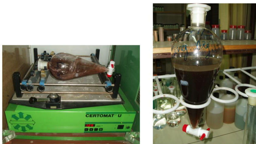
Figura 5.17 - Preparação da fase orgânica: agitação e decantação das duas fases (O/A=0.19).
