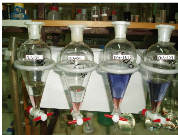
Figura 5.37 - Decantação das duas fases após contacto do extractante carregado com a solução de lavagem (2) contendo Cd.
