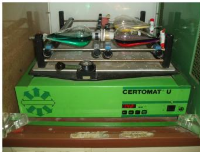
Figura 4.4 - Ensaio de extracção com solventes sem controlo contínuo de condições operacionais, realizados em agitador orbital.
