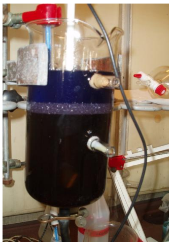
Figura 5.35 - Preparação da fase orgânica: decantação das duas fases ( O/A=0.37 ).
