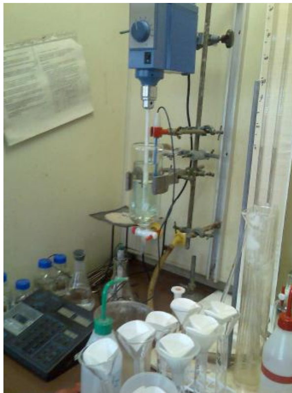
Figura 4.3 - Montagem experimental nos ensaios de extracção com controlo de pH.
