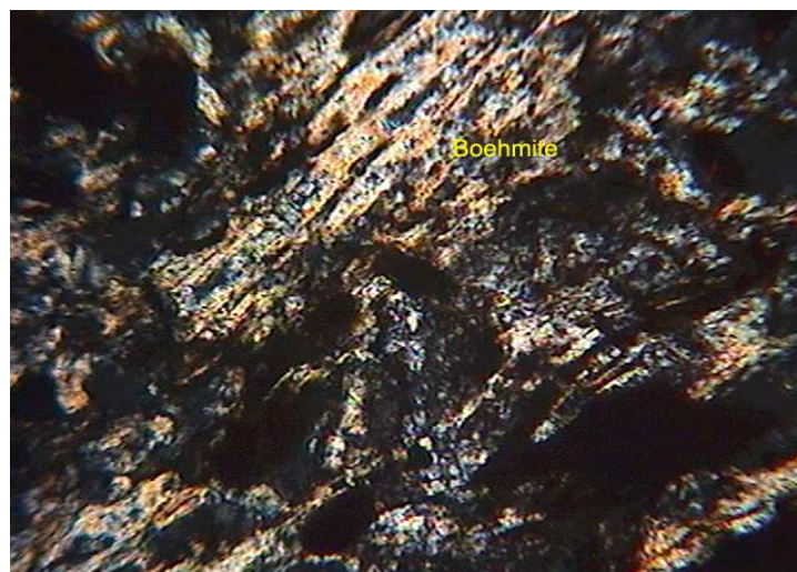
Figura 5.9 - Micrografia obtida em MO a 45°. Identificação de um cristal de boehmita envolto por cristais de gibbsita e goethita utilizando aumento de 20x em luz polarizada.
