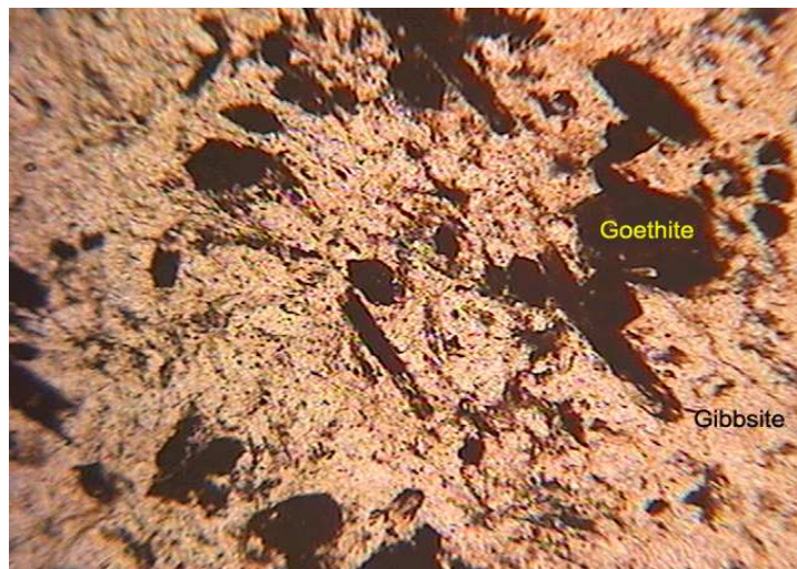
Figura 5.6 - Micrografia obtida em MO: Identificação dos cristais de gibbsita e goethita utilizando aumento de 10x em luz natural.
