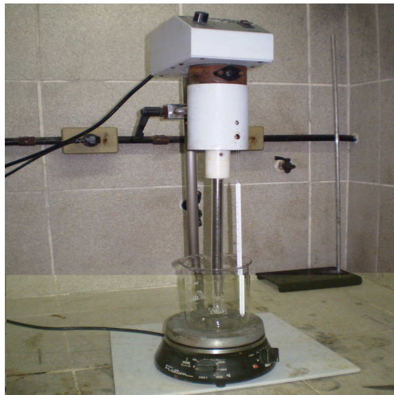
Figura 4.3 - Sistema montado para a reação de dissolução do ferro contido na bauxita.
