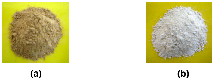
Figura 5.34 - (a) Bauxita “ in natura ”; (b) Bauxita beneficiada quimicamente em HCl por 90 minutos a 80°C.
