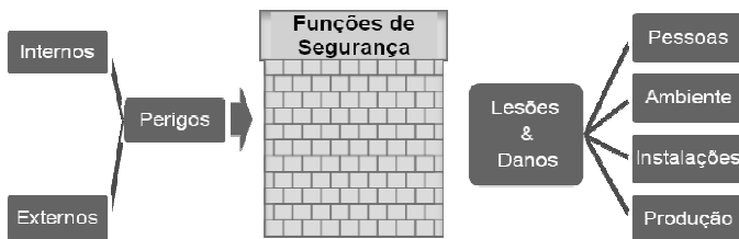
Figura 1.4 – Modelo Geral das Funções de Segurança (adaptado de Harms-Ringdahl (2001, p.156)
