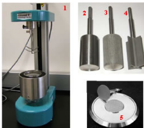
Figura 3.15 Tipos de geometria utilizados para ensaios reológico de pastas de cimento e argamassas, 1-“espinha de peixe”; 2 - cilindro concêntrico liso, 3 - cilindro concêntrico ranhurado, 4 - cilindro concêntrico aletado ( vane ) e 5 - placas paralelas ranhuradas.
